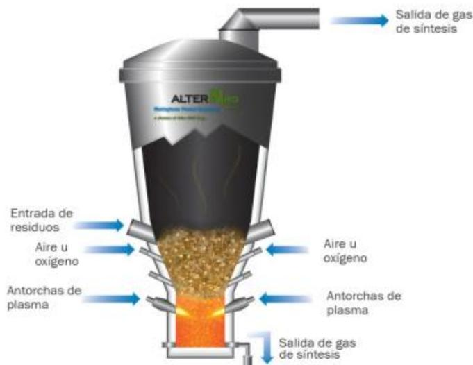
**Figura 14.** Reactor de gasificación por plasma Westinghouse (Westinghouse Plasma Corporation, 2013).
