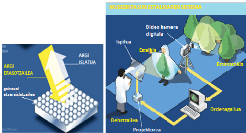
3a. irudia: Ezkerreko irudian argi ikusten da zer gertatzen den argiak gainazal atzeraislatzaile bat erasotzen duenean: etorri den bidetik bueltatzen da. Eskuinekoan, Tachi-k garatutako muntaketaren eskema dugu.
