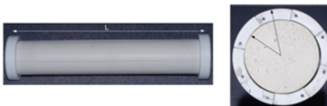
11. irudia: Ezkerrean zilindro dielektrikoa dugu, eta eskuinean zilindroaren sekzio bat ikusi daiteke, non kapa plasmonikoak zilindroa inguratzen duen.
