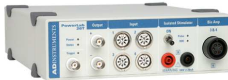
Irudia 10: PoweLab sistema, seinalearen eskuraketa (A/D bihurgailua) eta egokitzapen sistemak (anplifikagailua, iragazkiak...) integratuta dituelarik
