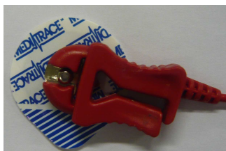
Irudia 16: EKG eta BI seinaleak eskuratzeko erabiliko diren elektrodoak.
