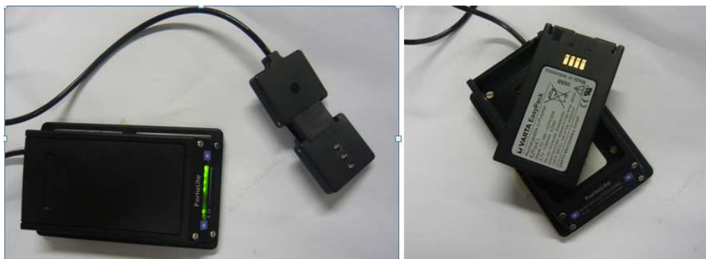
Irudia 25: Aldi berean A/D bihurgailua eta bateriaren euskarria den ArtiNIRS-eko PortaLite sistema.
