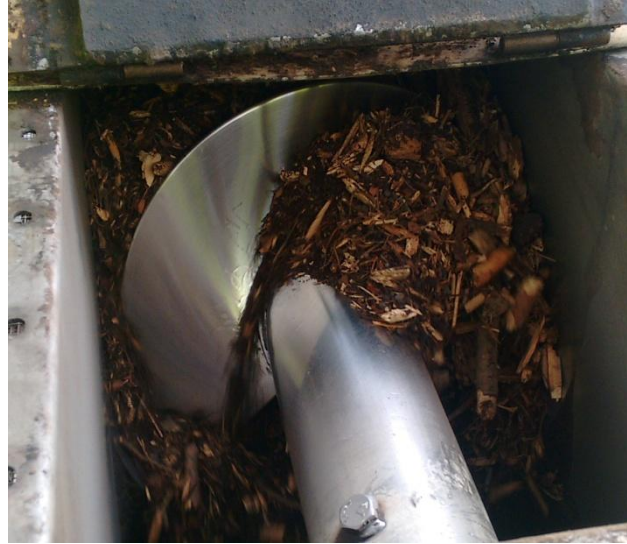
Imagen 42. Mezcla de biomasa empujada para entrar a caldera
