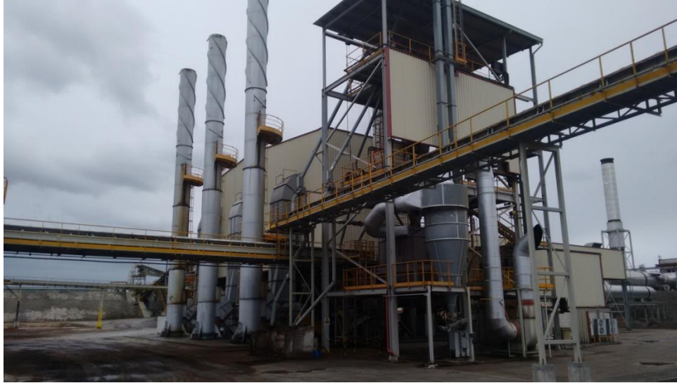
Imagen 28. Granuladora a la salida de los secaderos
