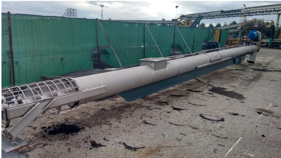
Imagen 20. Sistema de transporte. Tornillo sin fin
