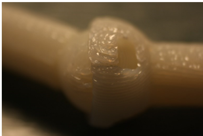
Ilustración 15 – Rotura en el casquillo
