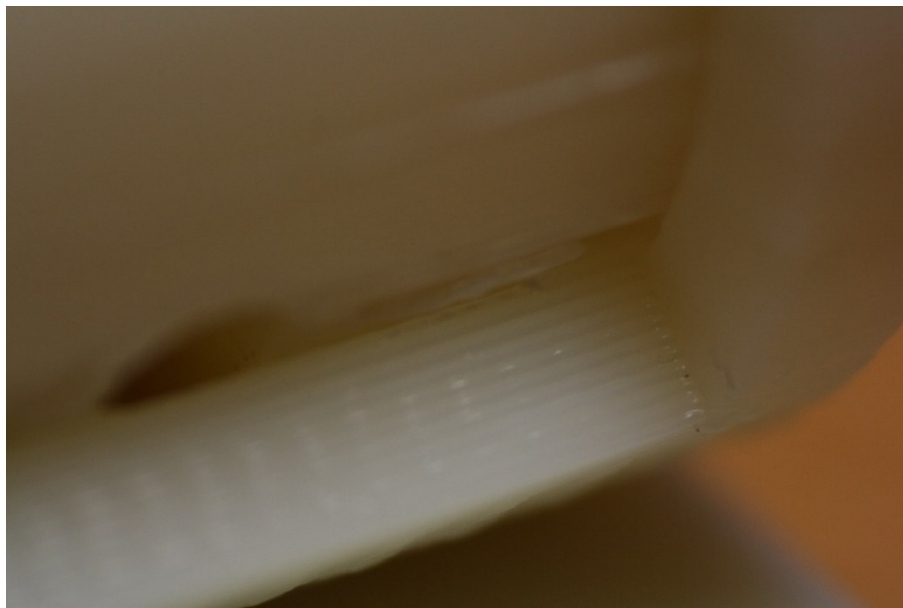
Ilustración 33 – Daños en la zona de contacto
