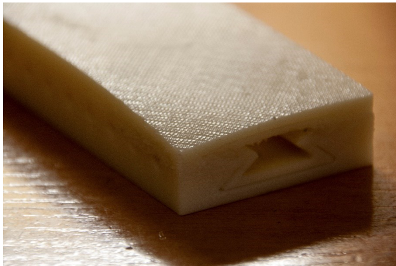
Ilustración 20 – Bloqueo por deformación
