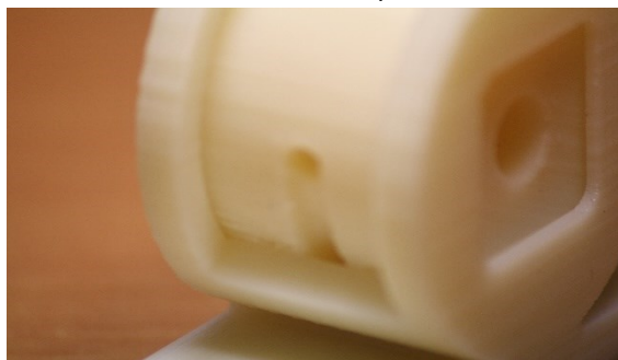
Ilustración 34 – Canales de limpieza en par rotacional
