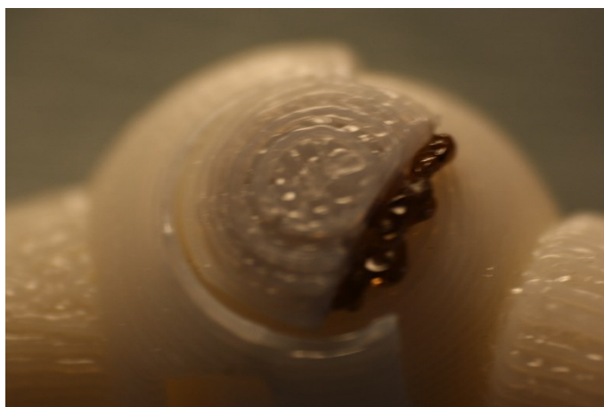
Ilustración 16 – Rotura por material de soporte no disuelto
