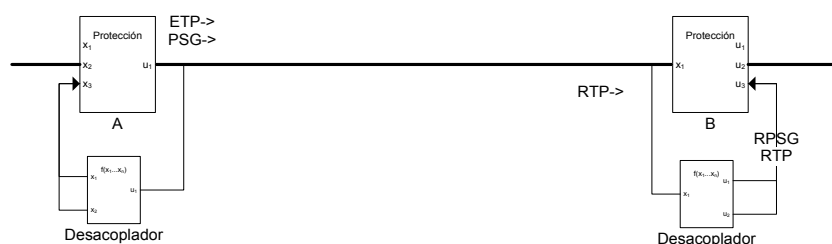
Figura 95 Esquema básico de teleprotección
