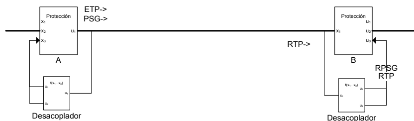
Figura 115 Esquema básico de teleprotección
