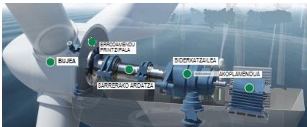
Irudia 2.3: Aerosorgailu estandar baten transmisioaren eskema.
