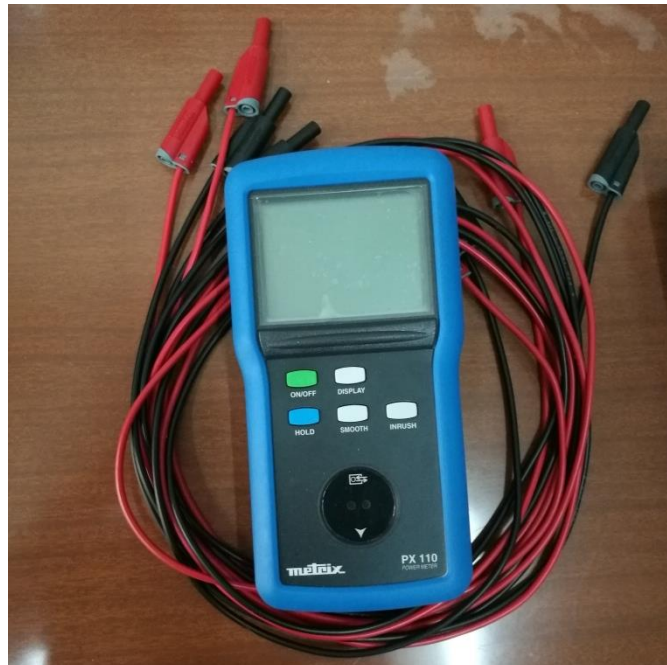
Ilustración 26. Vatímetros del equipo de laboratorio.
