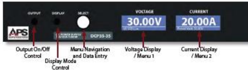
Ilustración 11. Cara frontal de la fuente de alimentación programable.
