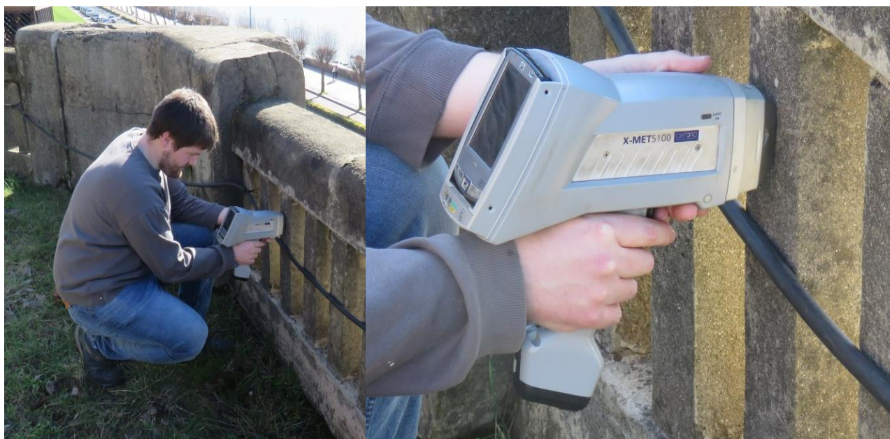
Figura nº 3. Análisis in situ con el equipo de fluorescencia de rayos x portátil.
