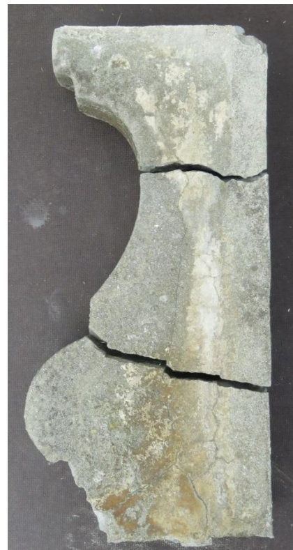
Figura nº 44. Balaustre modelo A fracturado correspondiente al tramo 55 nivel 3.2019.
