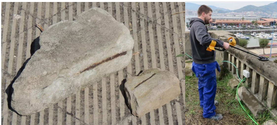
Figuras nº 17 y 18. Fragmentos de un balaustre del modelo A con restos de una armadura metálica y barrido con el detector de metales.
