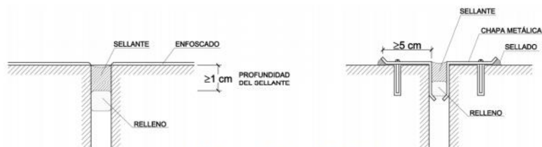
Figura 2.6 Ejemplos de juntas de dilatación
