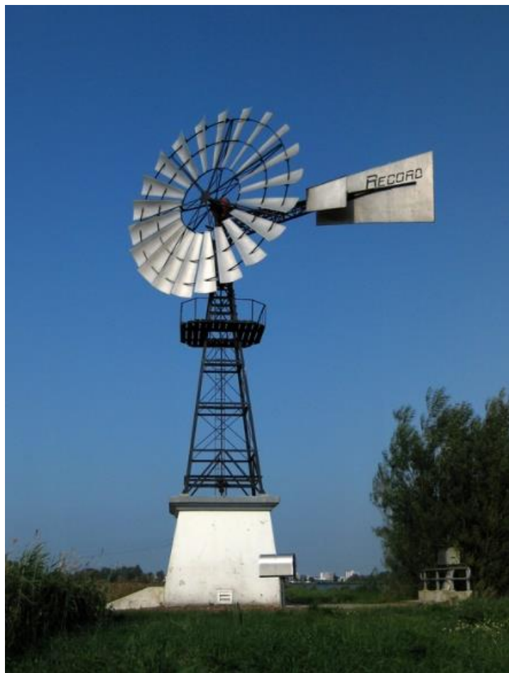
2.8. Irudia: Errotore multipaladun aerosorgailua
