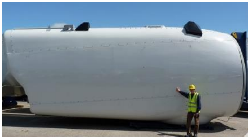
2.19. Irudia: Aerosorgailu baten gondola
