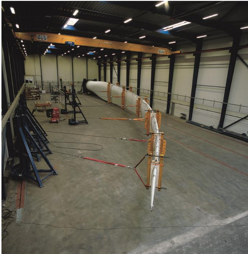
2.17. Irudia: Aerosorgailu handi baten pala bat entsegu bat jasaten
