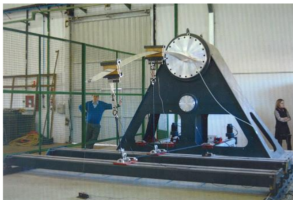
2.16. Irudia: Aerosorgailu txiki bateko palaren entsegua
