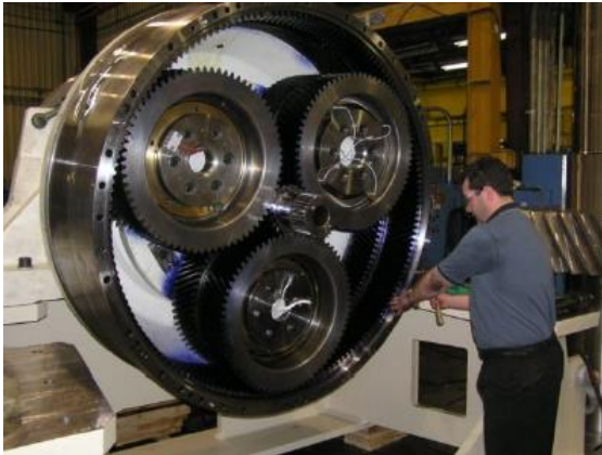
2.25. Irudia: Etapa planetariodun biderkatzailea
