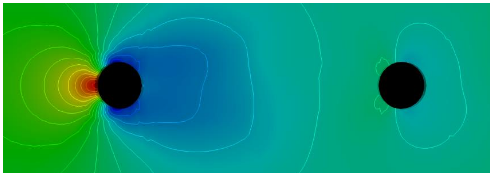
Irudia 5-3. L=6D , Re=100 fluxuaren noranzkoa eta presio banaketa t=10 aldiunean.
