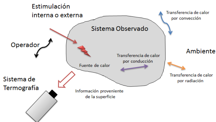
Figura 3-1. Los actores en un experimento termográfico y los fenómenos físicos que intervienen en la medición.
