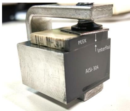
Figura 4-10. Piezas de materiales puestas en contacto y cubiertas con una capa de grafito. a) Conjunto PEEK/AISI-304. b) Conjunto Cobre/ AISI-304.
