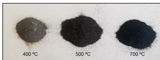
Figura 5.16. Imagen de las muestras de dolomita desactivada estudiadas en la termobalanza a diferentes temperaturas.
