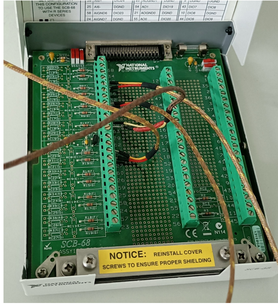
(a) 4 termopares tipo K conectados de manera diferencial al terminal SCB-68.
