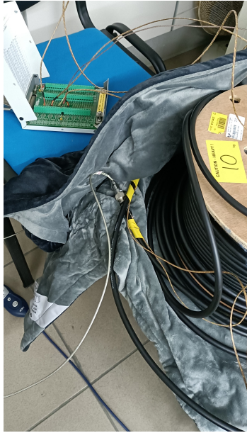
Figura 13: Cable coaxial y termopares cubiertos por la manta eléctrica.
