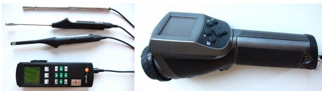
Imagen 96: Equipos empleados para las mediciones de las condiciones microclimáticas en las plazas. Fotografías de la autora.
