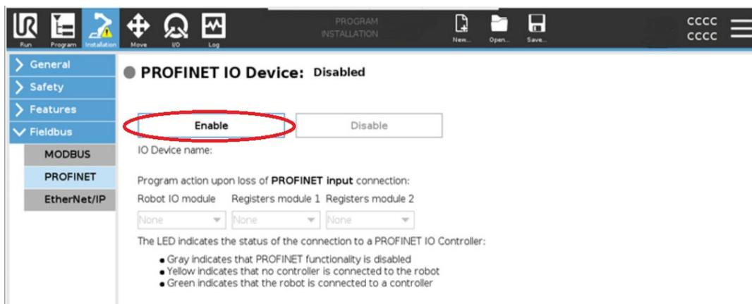
Figura 5. 3. Configuración Profinet en la instalación del robot
