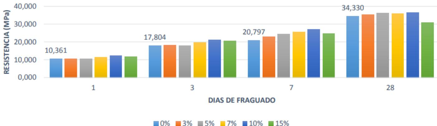
Ilustración 16 Resistencias a compresión a 1, 3, 7, 28 días de fraguado con 0%, 3%, 5%, 7%, 10%, 15% de residuos cerámicos [25]
