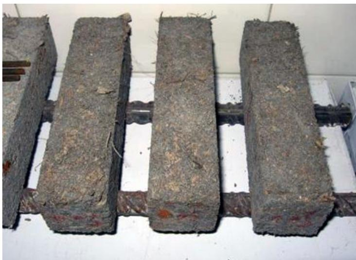
*Ilustración 11 Hormigón con cenizas de bagazo de caña de azúcar*
