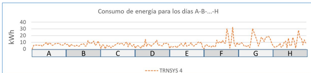
Figura 41. Consumo de energía horario de TRNSYS 4 en los días A-B-...-H.
