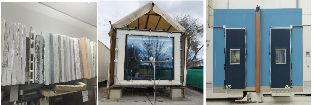
15. Irudia: Arlo termikoa (a) inguratzailentzako materialak, (2) Paslink zelda dinamikoa (3) guarded box testa
