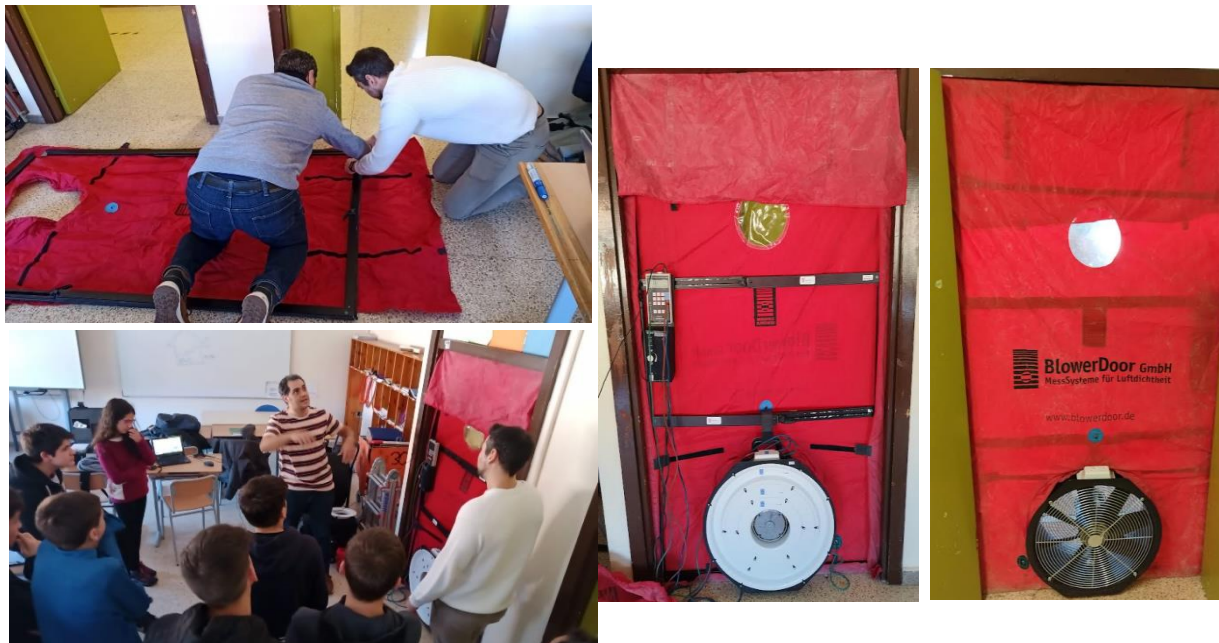
10 Irudia: Blower Door saiakera Deustuko Ikastolan
