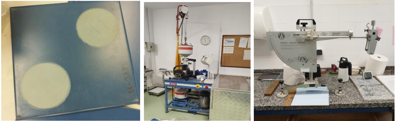
17. Irudia: (1) Baldosen entsaio baten emaitza, (2) trakzio entsaioa (3) irristatzeko ahalmena neurtzeko makina
