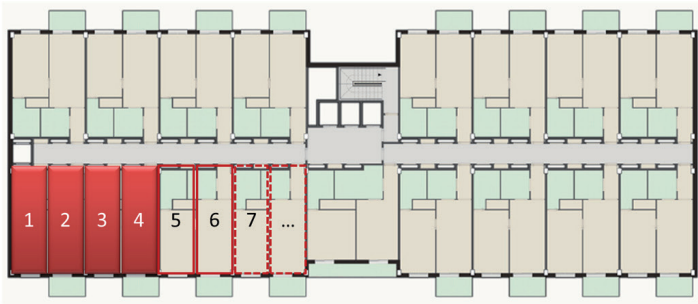
Fig. 4. El esquema propuesto consiste en un corredor central que sirve a una serie de módulos legales independientes que permiten su adaptación espacial a las necesidades de las familias. La configuración espacial de los edificios es abierta, tanto en el momento de construirse como a lo largo de su vida útil.
