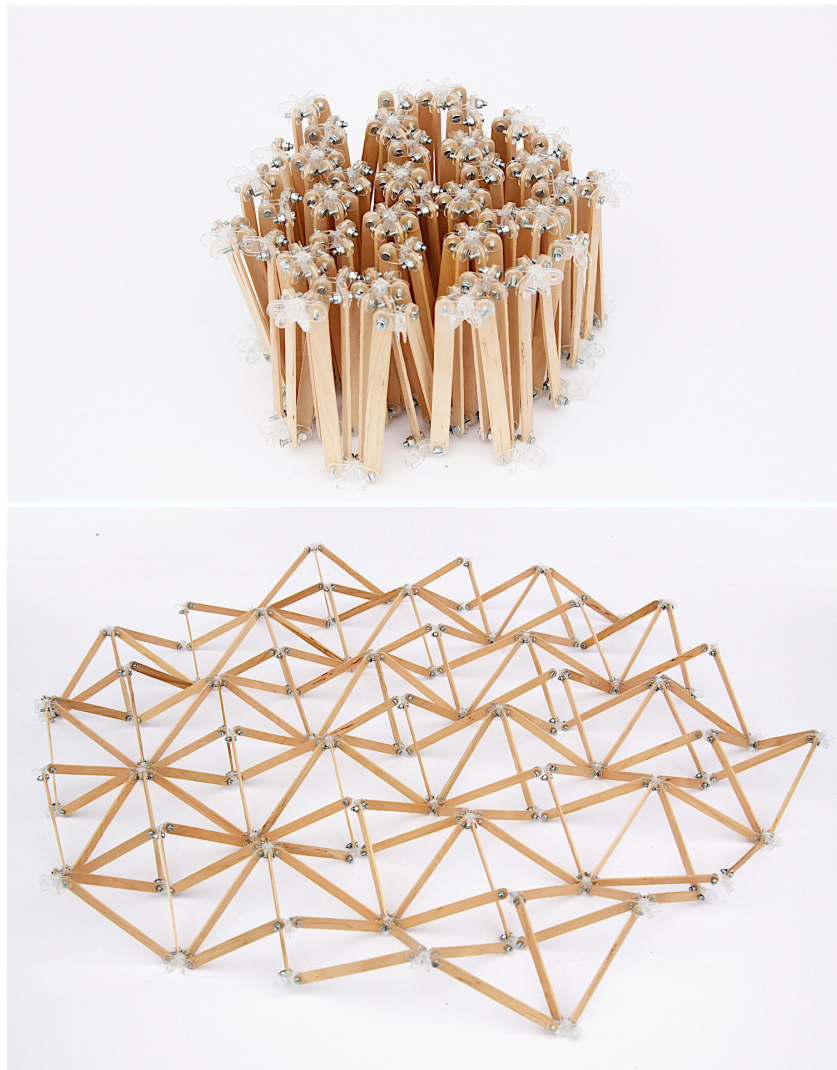
Malla generada con mecanismos de nudos de tres barras girados en estado plegado y desplegado
