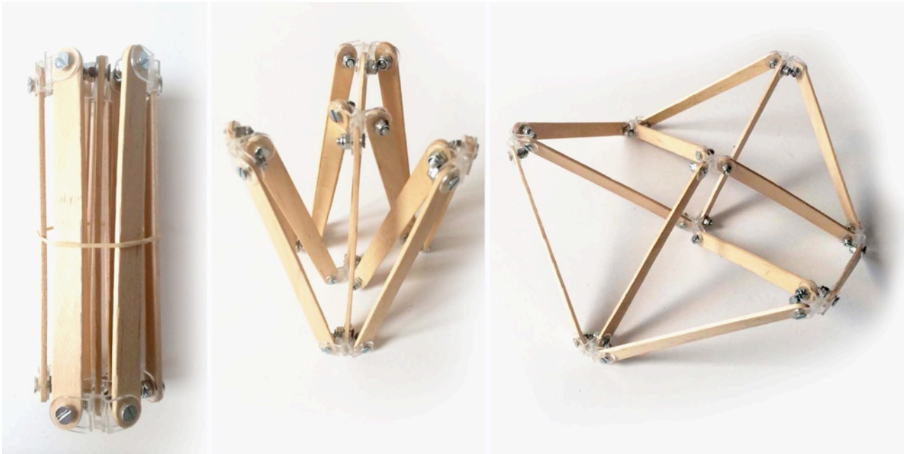
Maqueta de mecanismo de nudo de tres barras girado
