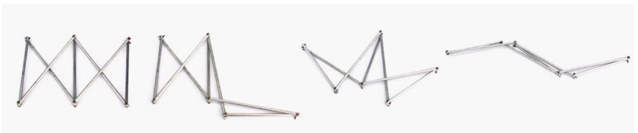
Secuencia de plegado de dos T-2 con barras verticales
