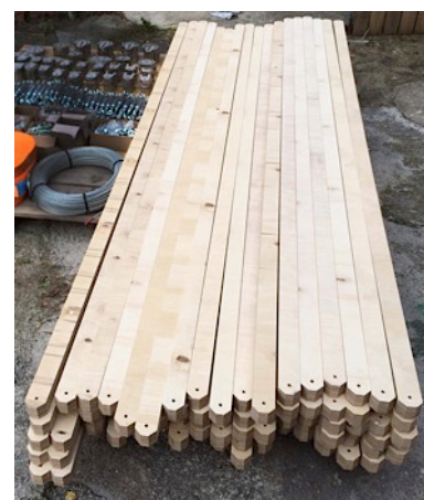
Barras de madera microlaminada de 40 \times 50 \times 2500\text{mm}
