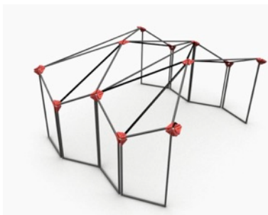
Estructura desplegable con uniones formadas por una combinación de bisagras dispuestas en diferentes direcciones (Temmerman 2007)
