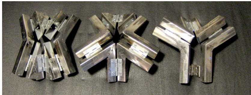
Uniones articuladas formadas por la combinación de bisagras dispuestas en diferentes direcciones (Temmerman 2007)
