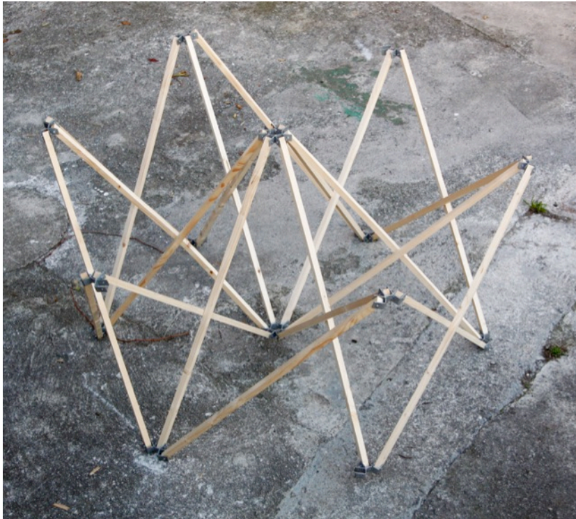
Maqueta a escala intermedia (1/2) de un módulo hexagonal de barras cruzadas
