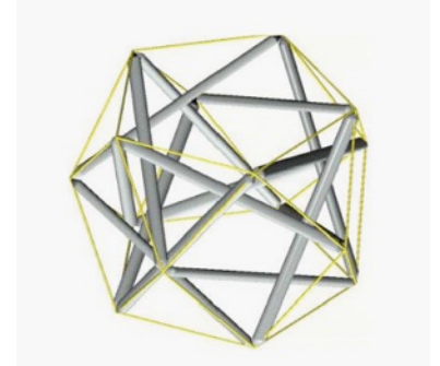
Tensegrity falsa a partir de un poliedro realizada uniendo las aristas con circuitos de barras (Motro 2009)
