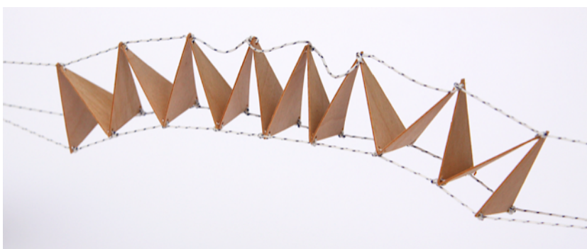
Maqueta de estructura tensada de directriz curva con elementos comprimidos en contacto. Las secciones exteriores a la tracción ejercida quedan destensadas
