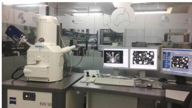
**Figura 3.2.** Microscopio de barrido SEM ZEISS (modelo EVO 50).
