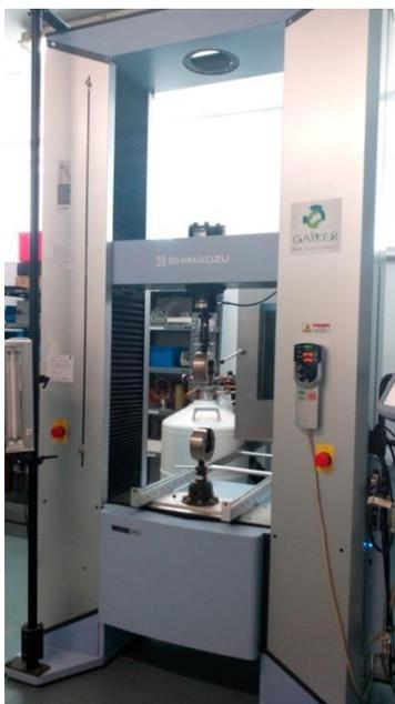
**Figura 3.10.** *Maquina universal de ensayos.*
