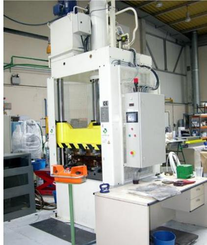
**Figura 3.3.** Prensa hidráulica de 80 t.
