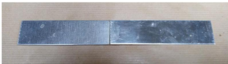
**Figura 4.47.** *Probetas polímero/metal a caracterizar.*
