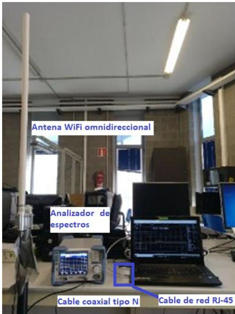
Figura 21. Equipamiento utilizado para las medidas.
