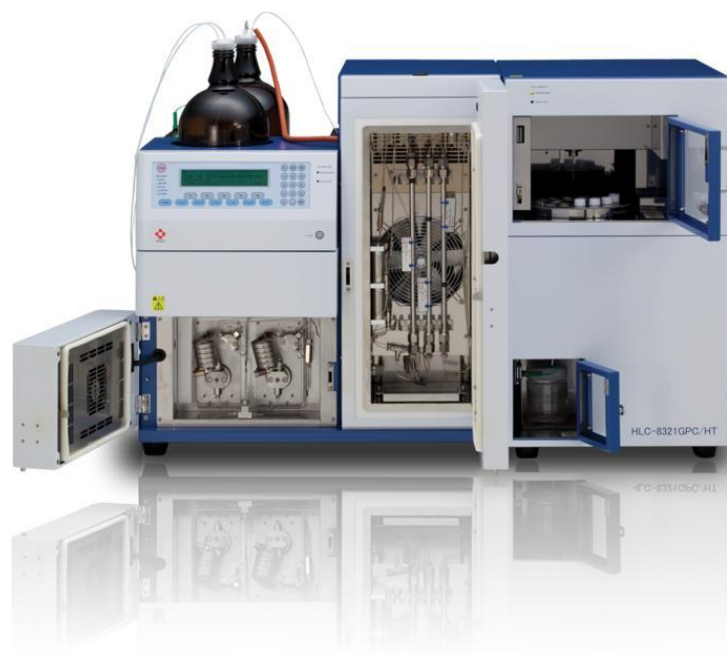
Figura 8. Ejemplo de un equipo GPC.
