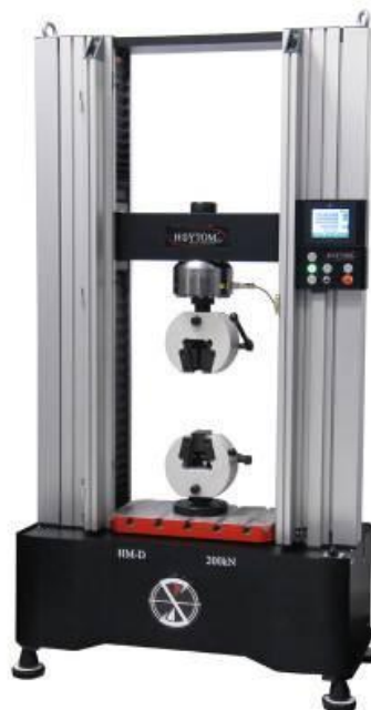
Figura 9. Ejemplo de un equipo empleado para el ensayo de tracción.
