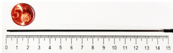
38. irudia: Proben ondoren egindako fabrikatutako tenperatura-sentsorearen argazkia.
