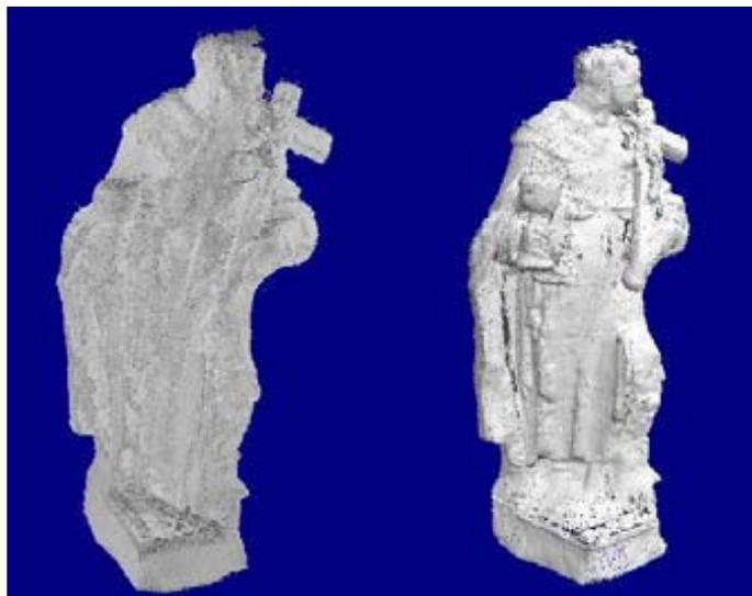
Figura. 2.- En la parte izquierda se presenta el modelo de una imagen en la que los puntos reciben el color obtenido del propio sensor, en la derecha, los mismos puntos pero con un nivel de gris calculado en función de una iluminación artificial el ángulo formado por dos vectores: el correspondiente a la fuente de luz y el normal a la superficie de incidencia.
