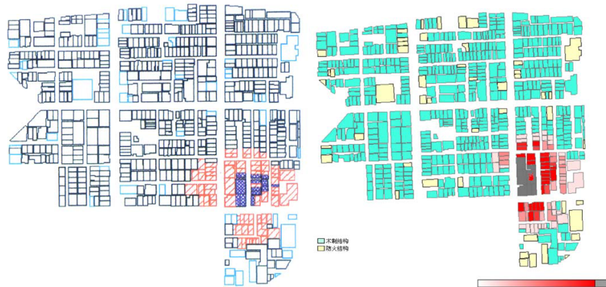
Figura 8.5: Propagación de incendio urbano en la ciudad de Kobe (Japón) tras un terremoto [35]. A la izquierda, la situación real al inicio del incendio. A la derecha, los resultados de la simulación virtual.
