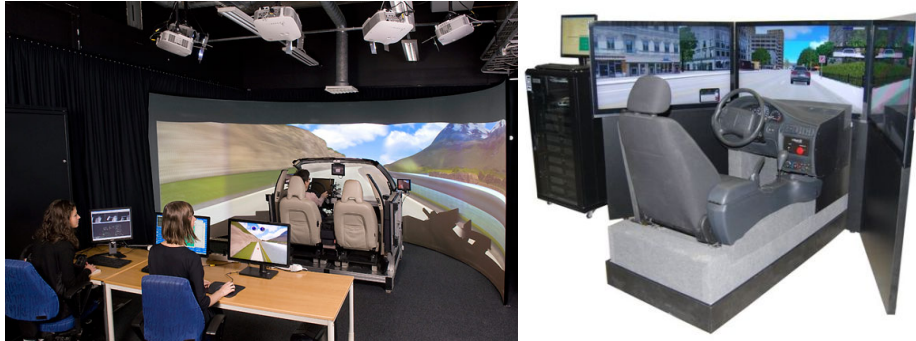
Figura 1.2: Simuladores de vehículos para formación. Izquierda: Simulador de Autotrim . Derecha: Simulador de Virage Simulation .
