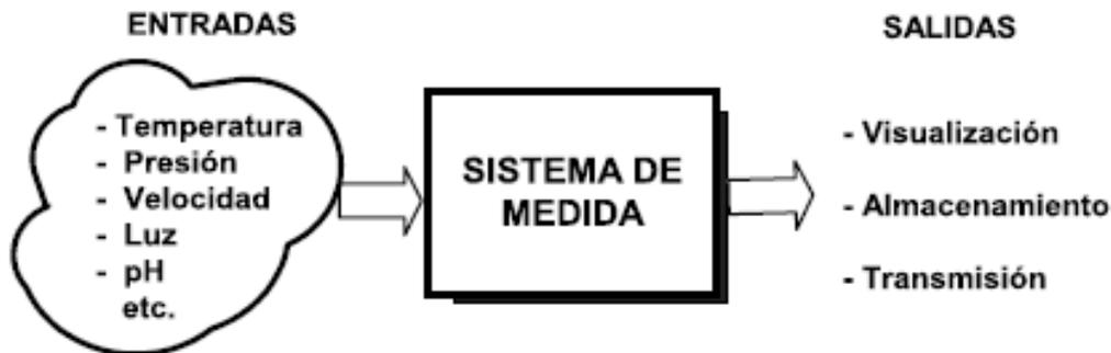
Figura 2. Descripción del proceso de adquisición de datos
