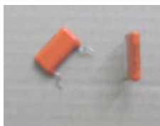
1.10 irudia. Poliesterrezko kondentsadoreak, kanpoko itxura
