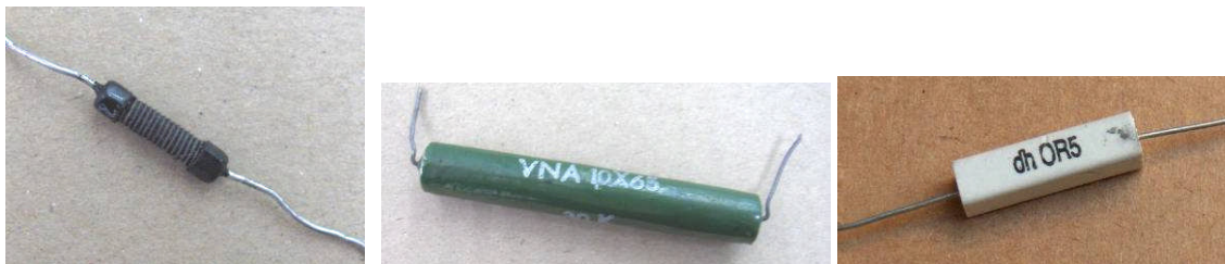
1.2 irudia. Hainbat erresistentzia harilkaturen itxura
