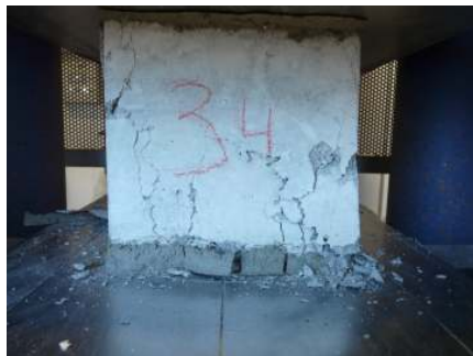
(a) Rotura de la probeta nº34
