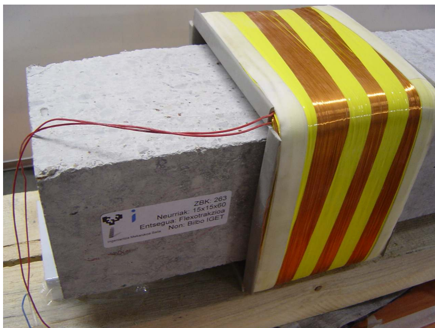
Figura 5.15: Medición de las probetas prismáticas.
