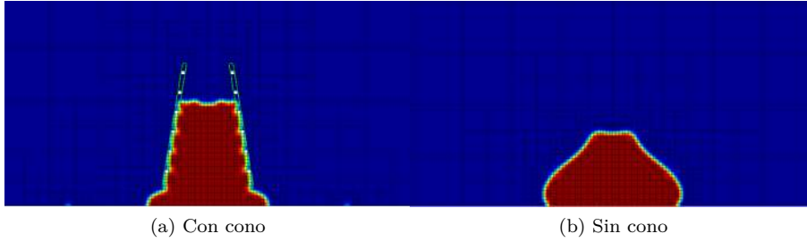
Figura 7.2: Diferencia de movimiento de la masa debido a la coacción del cono.
