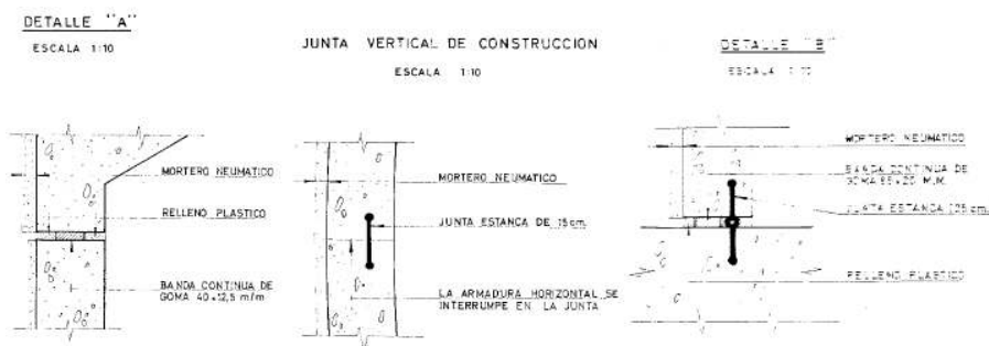
Figura 8.4: Detalles específicos de uniones y apoyos articulados.
