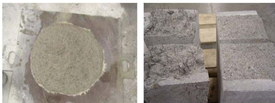
(a) Hormigón autocompactante (HAC) (b) Hormigón reforzado con fibras de acero (HRFA)
