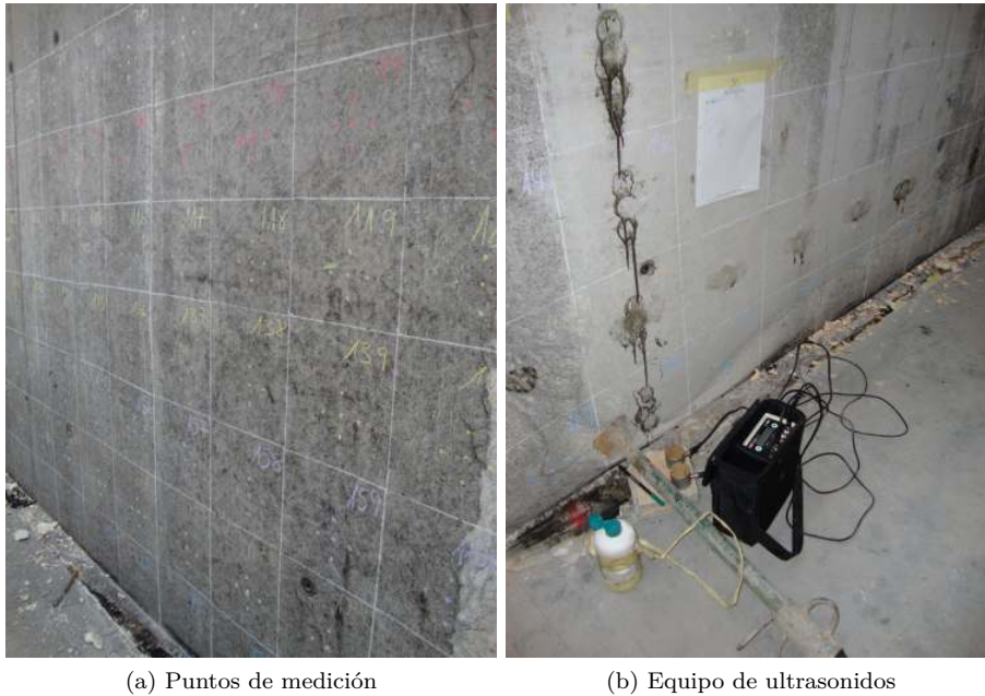
Figura 5.2: Puntos de medida y recepción de la onda ultrasónica.
