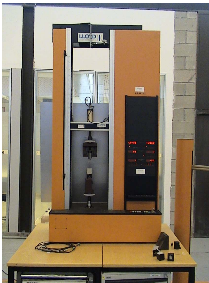
Figura 3.3: Máquina de ensayo empleada para el arrancamiento de las fibras.
