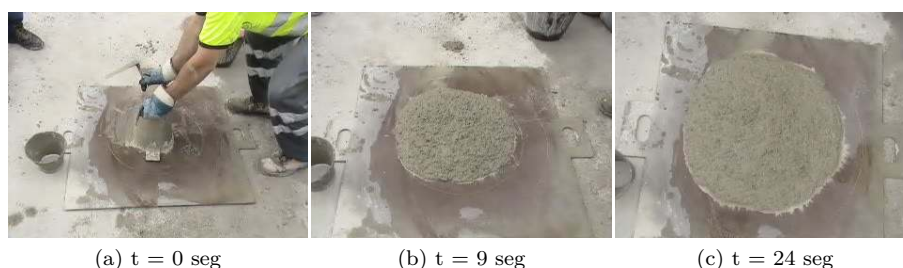
Figura 3.9: Esgurrimento de la amasada en laboratorio.
