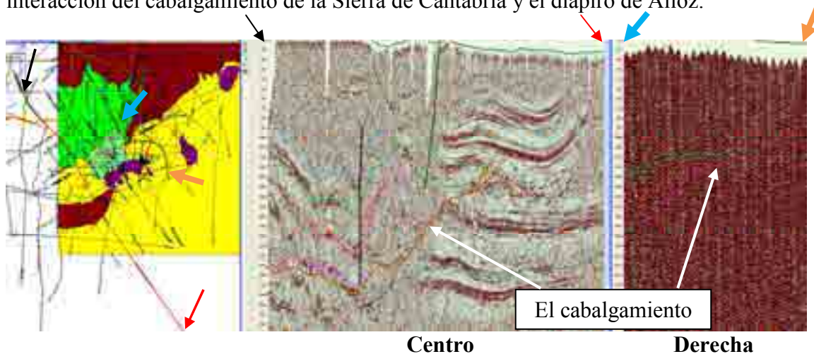
Figura 3-9. El cabalgamiento de la Sierra de Cantabria al oeste ( centro ) y al este del diapiro de Estella ( derecha ).
