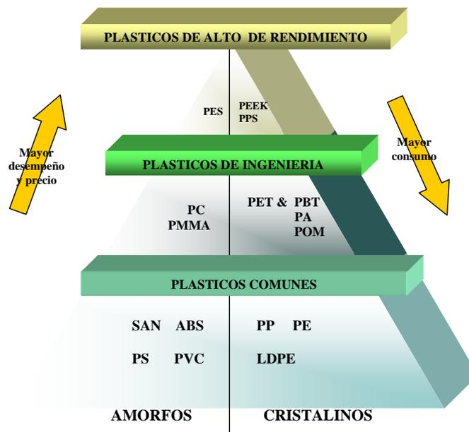
**Figura 1** Clasificación general de los termoplásticos [2]
