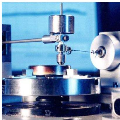
**Figura 44** Equipamiento para el estudio al desgaste y fricción
