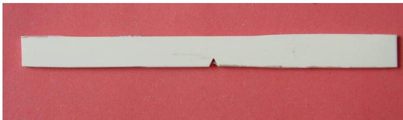
**Figura 43** Probeta mecanizada para ensayos Charpy
