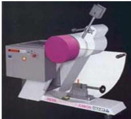
**Figura 42** Máquina de ensayos Charpy
