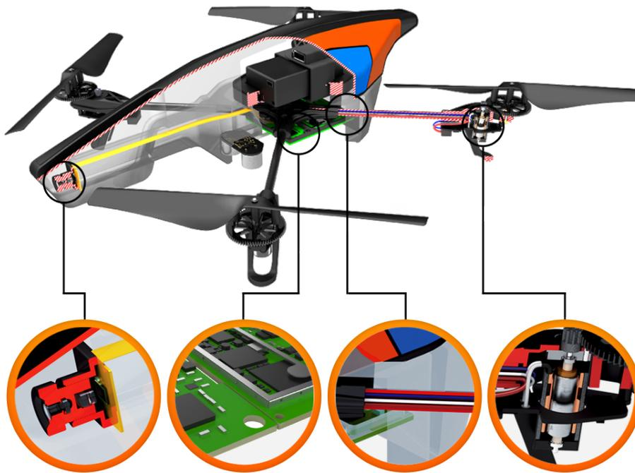
Figura 17: Actuadores del AR.Drone
