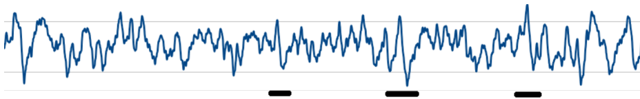
Fig. 3.2 ECG con ruido de origen AC con 3 complejos QRS subrayados en negro
