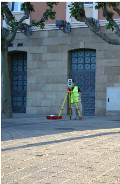
Fig. 8.- Observación de la poligonal entre estaciones.
