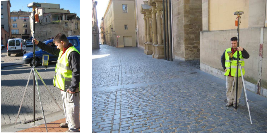
Fig. 9.- Observación mediante GPS de la red.
