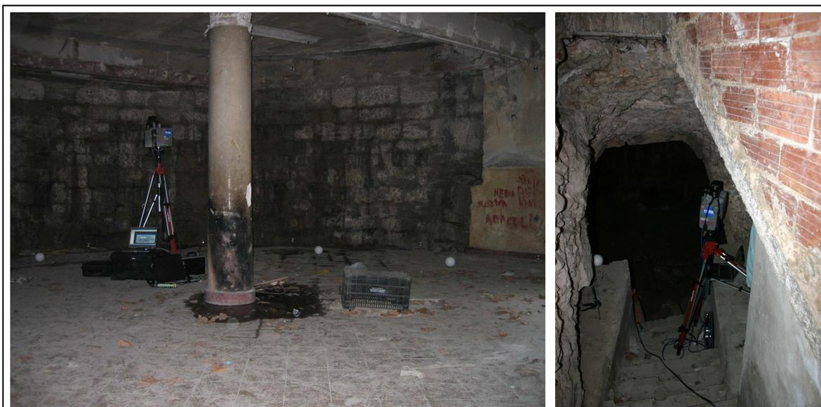
Fig. 3.- Dos momentos de la toma de datos en campo del escáner tridimensional.
