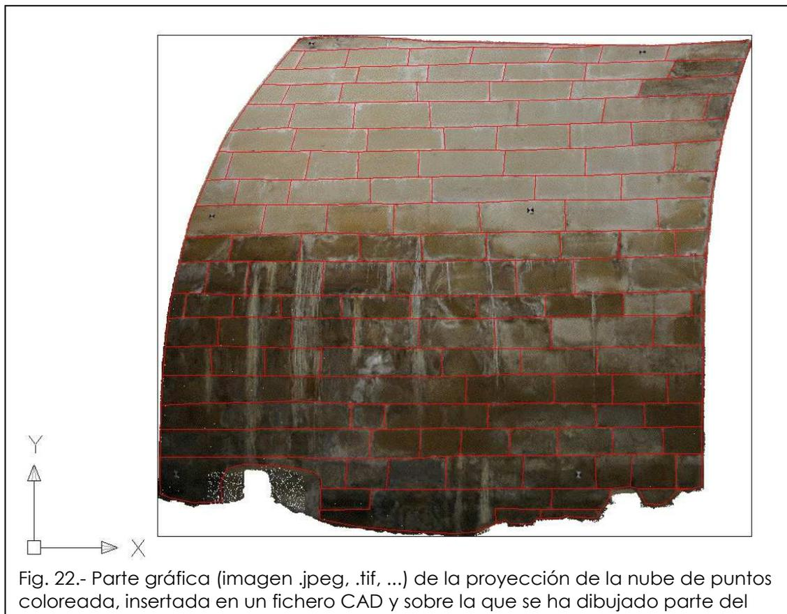
Estos vectores se insertan en el modelo tridimensional. En la siguiente imagen se puede apreciar el conjunto de líneas obtenidas del despiece del sótano, aunque no se consigue identificar la totalidad, la mejora respecto a las imágenes en escala de grises es muy significativa.
