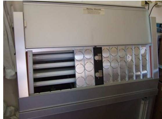
Figura 3. Máquina de foto-degradación abierta. Dentro se aprecian los tubos de rayos ultra violeta.
