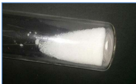
Figura 23.- Criogel obtenido tras el proceso de liofilización.
