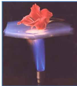
Figura 9.- La propiedad aislante del aerogel evita que la flor arda ante el fuego.
