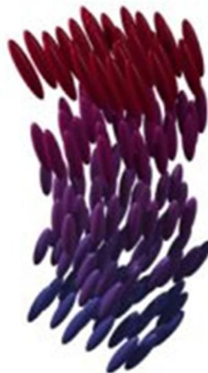
**Figura 1.8** Representación de la mesofase  $SmC^*$  (derecha). Se ve el tildado de las moléculas con respecto al normal a las capas y su helicidad[10].
