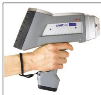
*Figura 12. Equipo portátil X-MET5100, empleado para el estudio semi-cuantitativo elemental de las muestras.*
