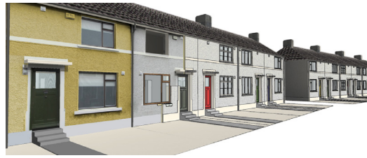
Fig. 6. Visualización tridimensional de la hilera estudiada, mostrando el aspecto exterior antes y después de la instalación del SATE
