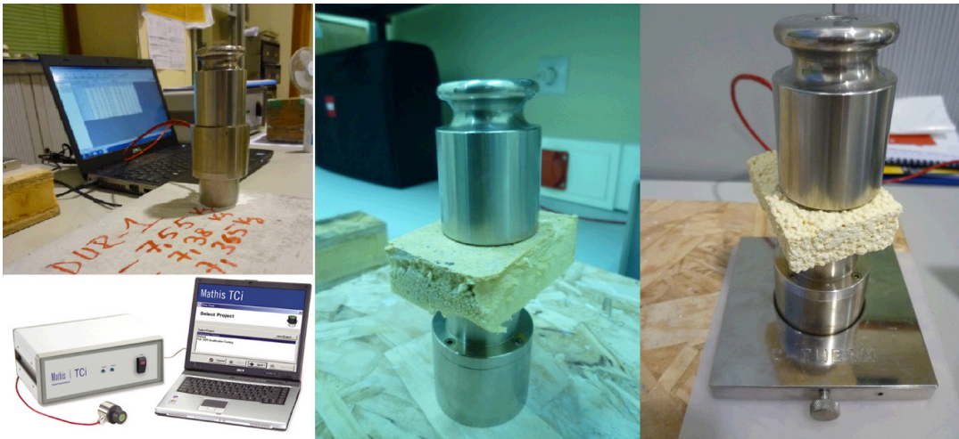
Fig. 2. Equipo TCI (abajo) y ensayo de caracterización térmica de los HLE (arriba), EPS (centro) y AISLONE (derecha). TCI equipment (below) and thermal characterization of LWC (left), EPS (center) and AISLONE (right).
