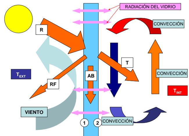
Fig. 22. Flujo Total de Energía a través de un vidrio.
