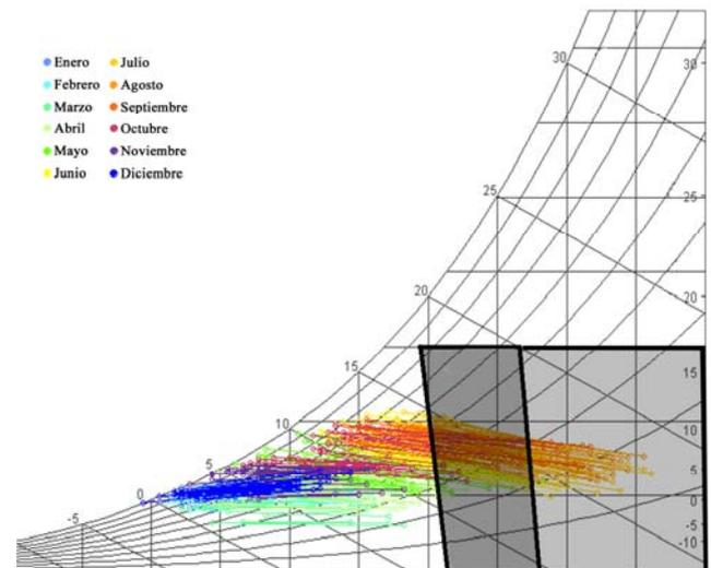
Fig. 13. Zona de masa térmica con ventilación nocturna.
