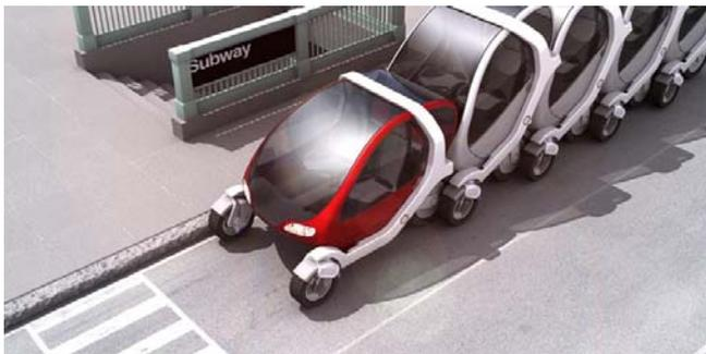
Fig. 11. Bit car. Concepto de vehículo eléctrico para uno o dos pasajeros para uso urbano. Tiene la capacidad de apilarse con otros coches semejantes, reduciendo así el área de aparcamiento. (Massachusetts Institute of Technology)
