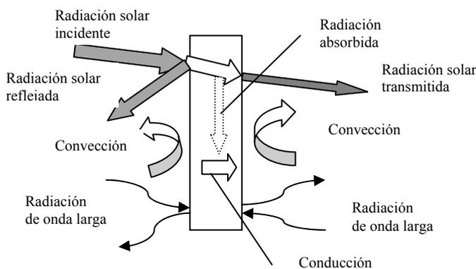
Fig. 20. Mecanismos de intercambio de calor en un vidrio.
