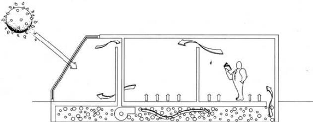
Fig. 32. La utilización de lechos de grava permite acumular calor en el suelo de forma económica y eficiente en edificios de poca altura dotados de cerramientos captadores. Distribución y acumulación del aire caliente a través de un lecho de grava bajo el suelo. (Fuente: Neila, J; 2004)
