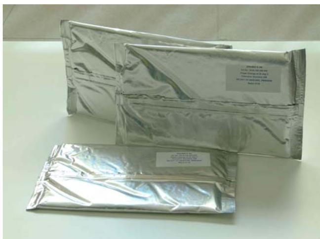
Fig. 9. Bolsas, placas y otro tipo de contenedores en cuyo interior se encuentra contenido un PCM. Son un modo cómodo y habitual de encapsular los materiales de cambio de fase para permitir su uso en construcción. Fuente propia.
