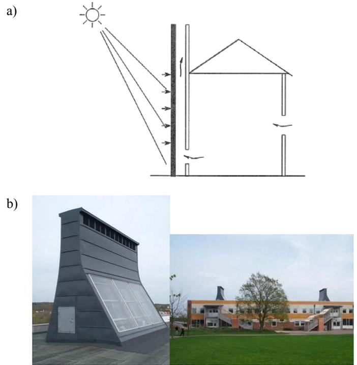
Fig.44. Ventilación inducida por chimenea solar a) esquema [2]; b) chimenea solar en la escuela Tångå en Falkenberg Suecia [95].
