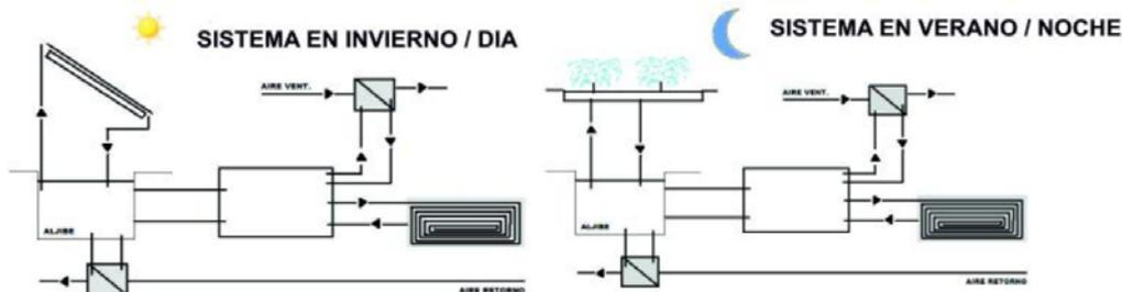
El condensador de las bombas de calor alimenta unidades terminales de suelo radiante.
