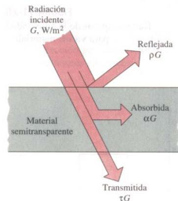
Fig. 11. Comportamiento de un material semitransparente ante la radiación incidente.
