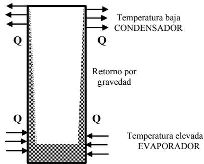
Fig. 13. Esquema de operación de un tubo de calor termosifónico.
