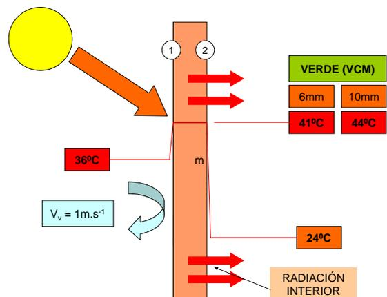
Fig. 27. Temperaturas en régimen cálido. Vidrio verde (VCM) de 6 y 10mm.
