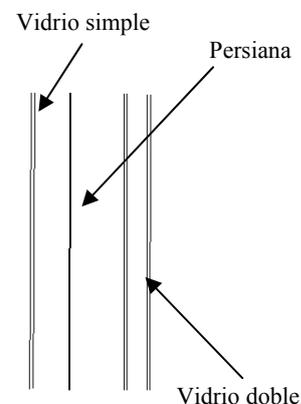
Fig. 23. Fachada ventilada vidriada.
