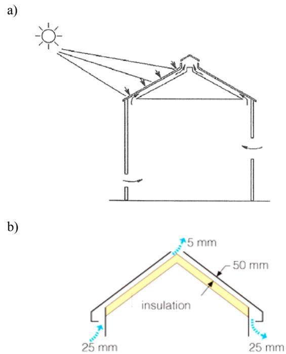
Fig.45. Ventilación inducida por tejado solar a) esquema [2]; b) disposición típica.
