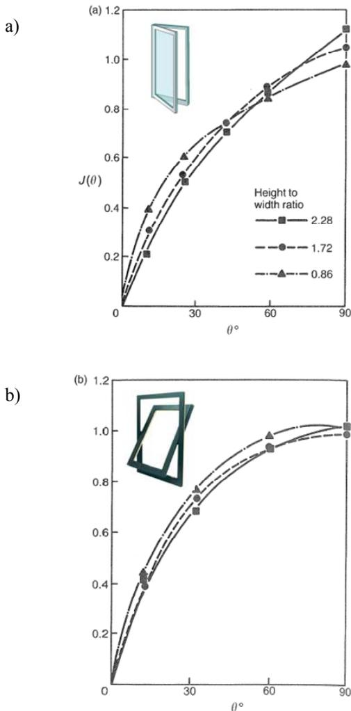
Fig.22. Efecto del ángulo de apertura  $\theta$  de una ventana sobre  $J(\theta)$
