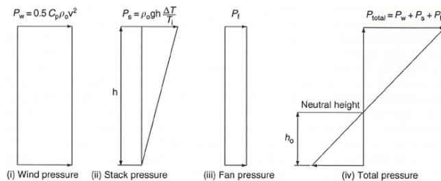
Fig.20. Componentes de la presión total: presión debida al viento; presión debida a diferencia de densidades; presión debida a ventiladores [2].
