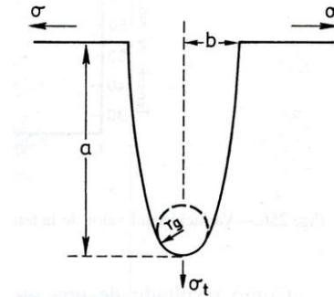
Fig. 46. Esquema de una microfisura elíptica y el esquema de tensiones que determina su evolución.
