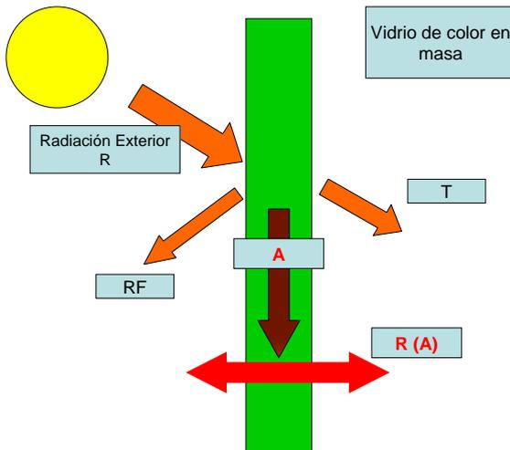
Fig. 26. Esquema de flujos de radiación.
