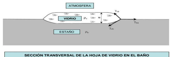
Fig. 8. Acciones sobre el vidrio fundido en el baño. [2] LE VERRE Capítulo 7. Fig. 7.25.
