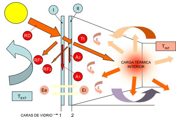
Fig. 40. Escenario térmico completo para un vidrio de fachada
