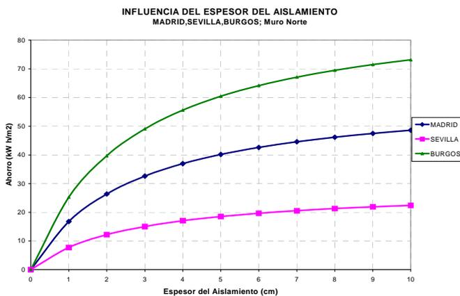
Fig. 19. Influencia del espesor de aislamiento para diferentes zonas climáticas.
