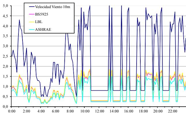
Fig.8. Resultados del ejercicio práctico 2. Velocidad de viento, en m/s, a 8 m de altura en Noain (Pamplona) para un día concreto, estimados mediante 3 métodos: BS, LBL y ASHRAE.
