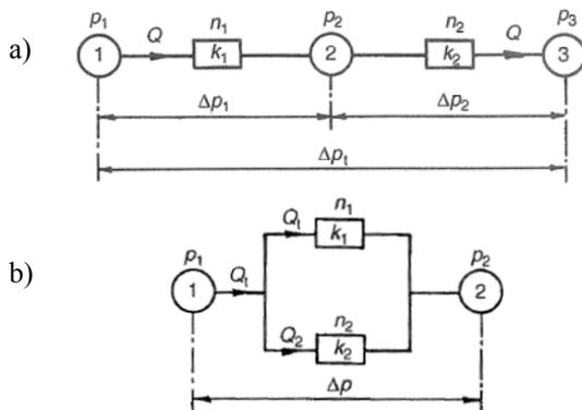
Fig.24. Trayectorias de aire. a) nodos en serie; y b) nodos en paralelo. [2].
