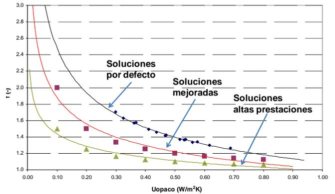
Fig. 25. Influencia de puentes térmicos en función de la calidad de los cerramientos.
