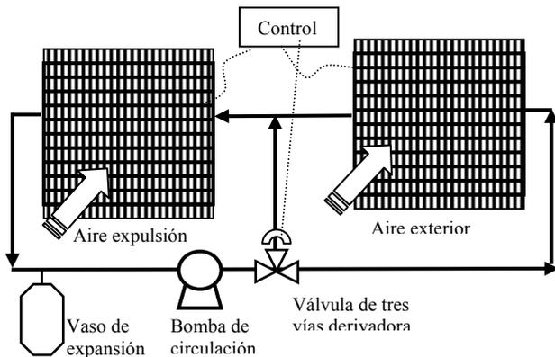
Fig. 9. Funcionamiento del sistema de dos baterías con bomba.
