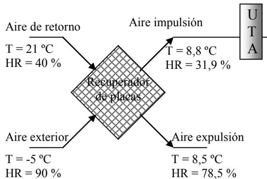
Fig. 20. Operación del recuperador de placas en ciclo de invierno, sin utilizar enfriamiento evaporativo.
