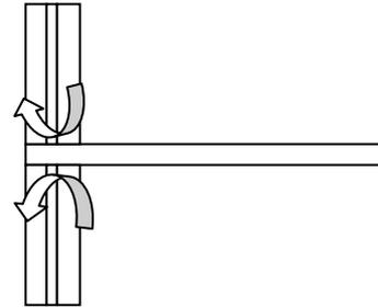
Fig. 18. Puente térmico formado por un frente de forjado.
