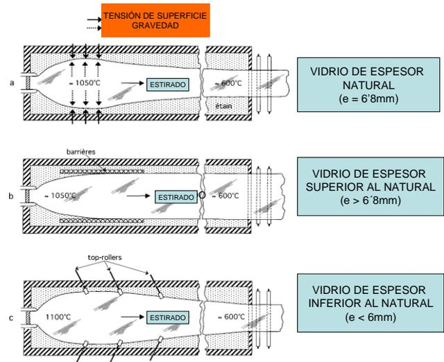
Fig. 7. Técnica de fabricación de los distintos espesores. [2] LE VERRE Capítulo 7. Fig. 7.26.
