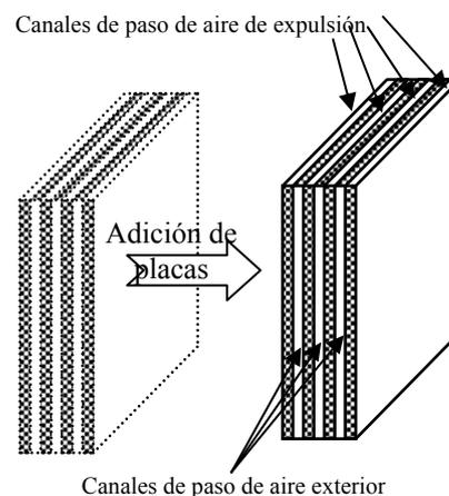
Fig. 3. Estructura de un intercambiador de placas.
