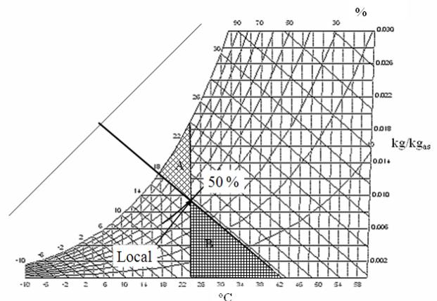
Fig. 30. Diferencia entre las zonas de control por temperatura y entalpía.
