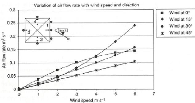
Fig.34. Captador de viento de sección cuadrada. Relación entre velocidad de viento, ángulo de incidencia y flujo de aire inducido [75].
