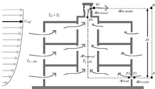
Fig.32. Estrategia de ventilación combinada debida a viento y a diferencia de densidades [57].
