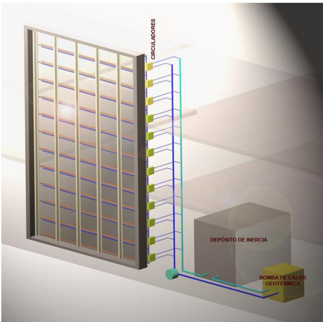
Fig. 59. Esquema de funcionamiento de los vidrios activos de cámara de agua en el muro cortina del Aulario. Cuenca, 2010. Figura extraída de: [http://www.intelliglass.es/index.php?option=com\\_content&view=article&id=118](http://www.intelliglass.es/index.php?option=com_content&view=article&id=118)
