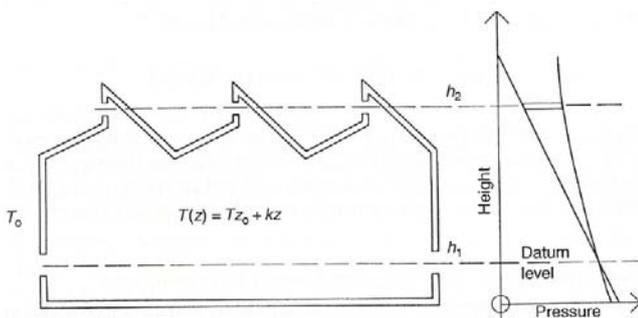
Fig.19. Presión debida a diferencia de densidades en edificios con gradiente de temperatura interior [2].
