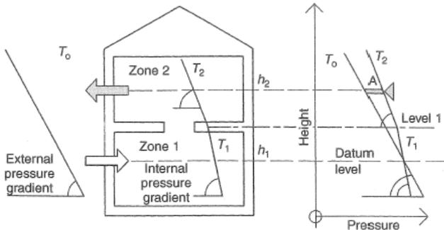
Fig. 17. Presión debida a diferencia de densidades con zonas verticales conectadas [2].
