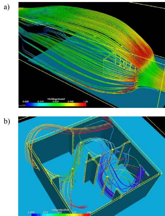
Fig.29. Trayectorias de flujo de aire a) flujo exterior al edificio; b) flujo en el interior del edificio [42].
