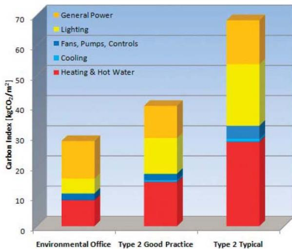
Fig.42. Emisiones de CO<sub>2</sub> en kg CO<sub>2</sub>/m<sup>2</sup> comparadas con otros edificios de oficinas [88].
