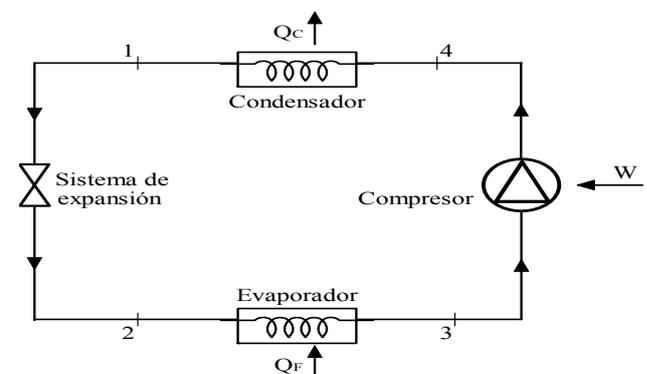
Fig. 4. Esquema de funcionamiento del ciclo simple por compresión de vapor.
