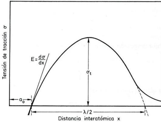
Fig. 45. Variación de las fuerzas de cohesión en función de la distancia de separación interatómica.
