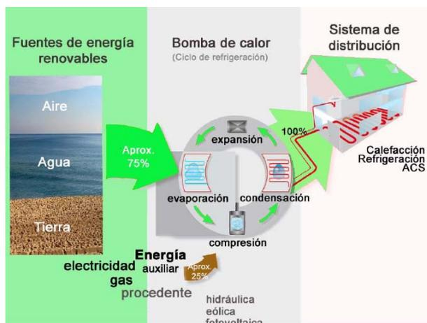
Fig. 1. Elementos intervinientes en el sistema de Bomba de Calor.
