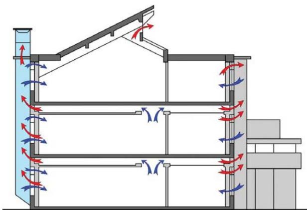
Fig.40. Estrategia de ventilación natural combinada en un día de verano en ausencia de viento en el edificio Environmental Building del BRE [88].
