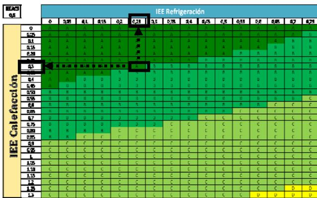
Fig. 35. Índices de Eficiencia Energética de Calefacción y Refrigeración que debe obtener el edificio final.
