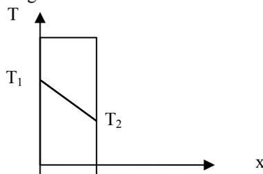
Fig. 8. Distribución de temperaturas en una pared.
