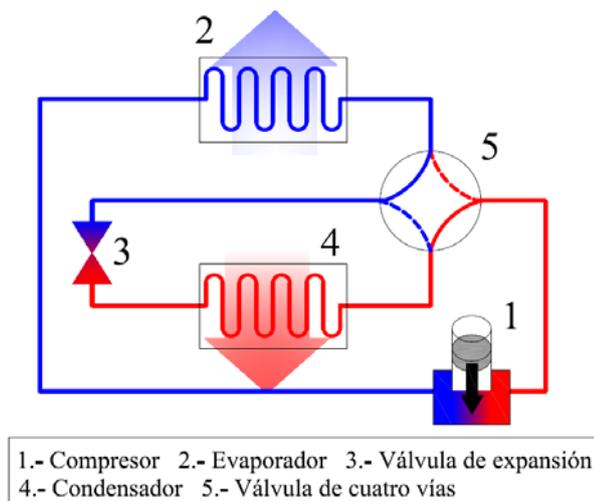
Fig. 3. Componentes de una Bomba de calor reversible.
