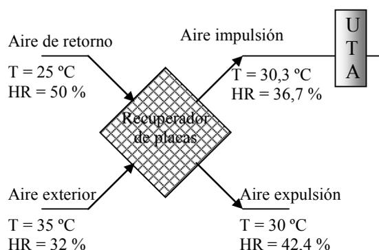
Fig. 21. Operación del recuperador de placas en ciclo de verano, sin utilizar enfriamiento evaporativo.
