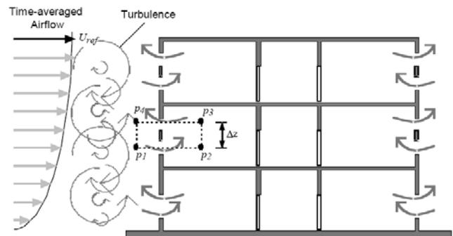
Fig.35. Estrategia de ventilación por una cara con flujo inducido por turbulencias. [75].
