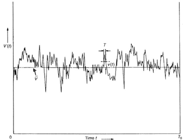
Fig. 1. Registro típico de velocidad de viento frente al tiempo [2].
