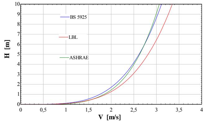
Fig. 6. Perfil de velocidad de viento, según BS5925 [6], LBL [7] y ASHRAE [8].
