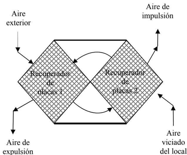
Fig. 6. Disposición en serie de dos intercambiadores de placas.
