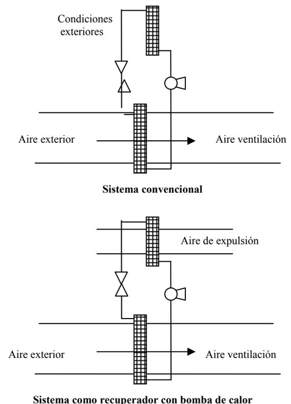
Fig. 16. Disposición de la unidad exterior de una bomba de calor.
