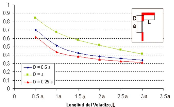
Fig. 18. Factor de control solar obtenido mediante obstáculos de fachada (voladizos superiores con orientación al Sur en verano).
