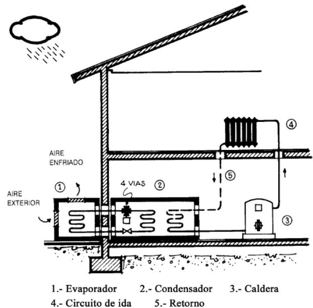
Fig. 7. Bomba de calor aire- agua apoyada por una caldera.
