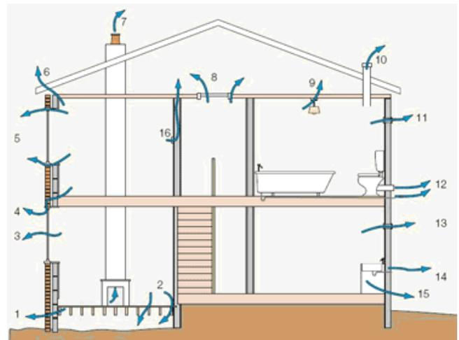
Fig.9. Flujos de aire en un edificio por pequeñas aperturas [9].
