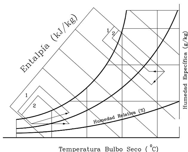
Fig. 17. Evoluciones psicrométricas de recuperación sensible y latente.
