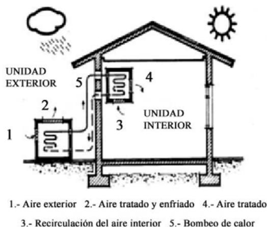
Fig. 6. Bomba de calor Aire- Aire.
