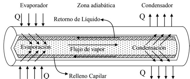
Fig. 14. Esquema de operación de un tubo de calor heat pipe.
