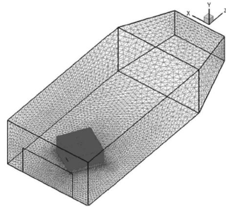
Fig.28. Dominio computacional empleando la aproximación acoplada [42].
