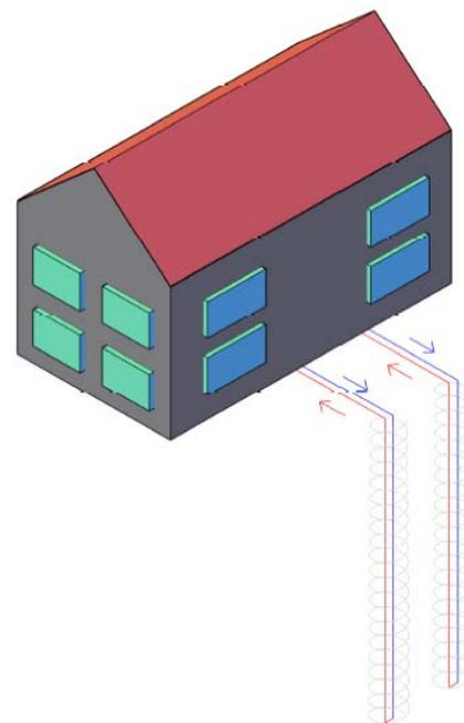
Fig. 14. Sondas geotérmicas junto a edificio.
