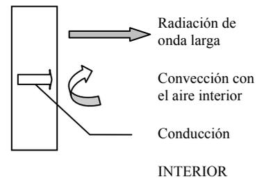
Fig.4. Mecanismos de intercambio de calor en una superficie interior.
