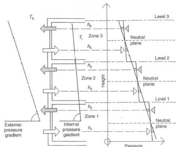
Fig. 16. Presión debida a diferencia de densidades con zonas verticales sin conectar [2].
