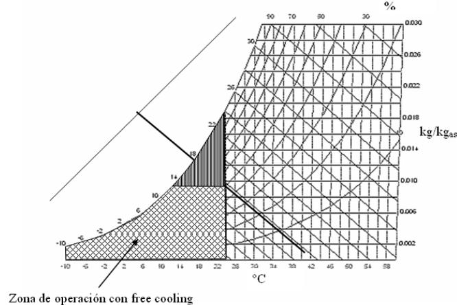
Fig. 29. Zona de control por temperatura en un diagrama psicrométrico.
