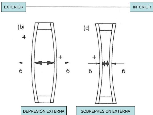
Fig. 55. Esquema de isócoras en una U.V.A. [8] prEN 13474. Parte 1: Fig. B-1.
