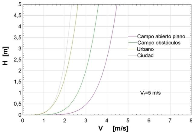
Fig. 5. Perfil de velocidad de viento, según BS5925 [6].
