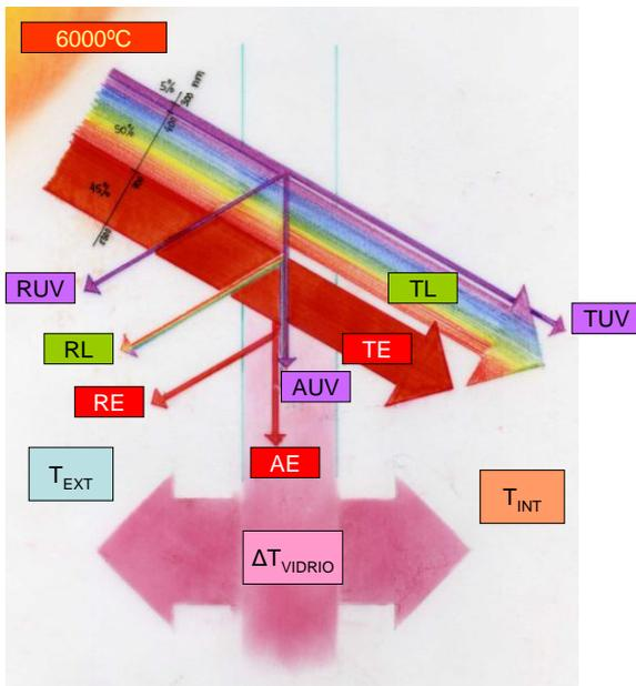
Fig. 20. Esquema del tráfico de la Radiación Solar en un vidrio.
