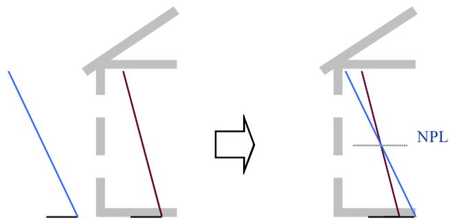
Fig.14. Gradiente de presiones del aire debido a diferencia de densidades.
