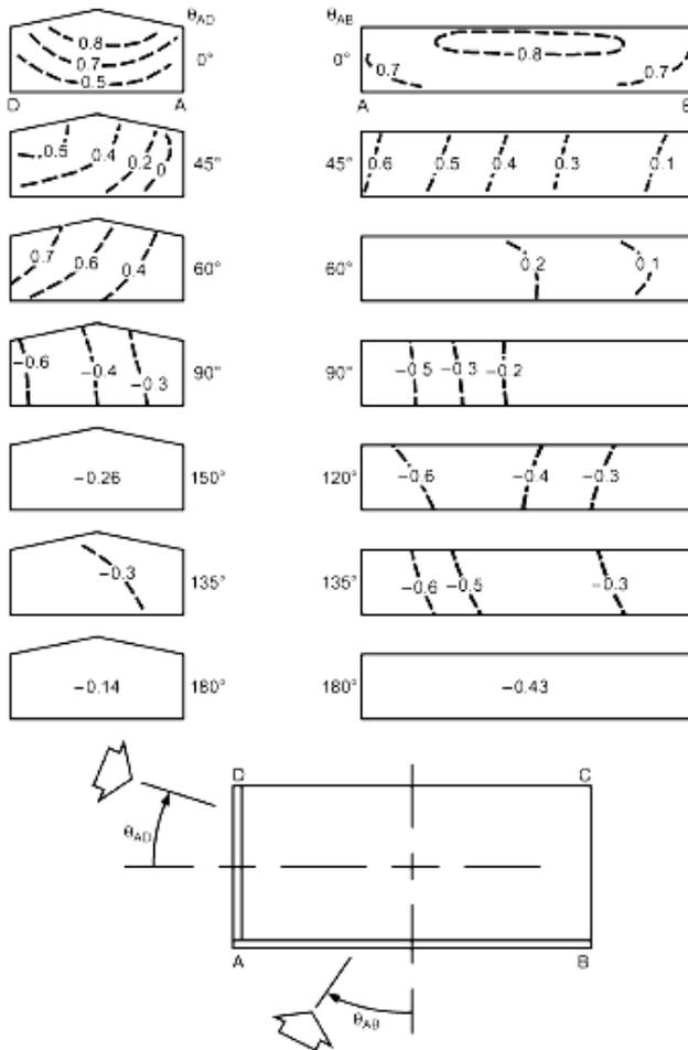
Fig. 11. Ejemplo de coeficiente de presión local en edificios de baja altura en función de la dirección del viento para fachadas [15].
