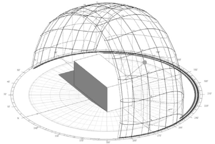
Fig. 27. Representación de la trayectoria solar en Caracas (ECOTECT).
