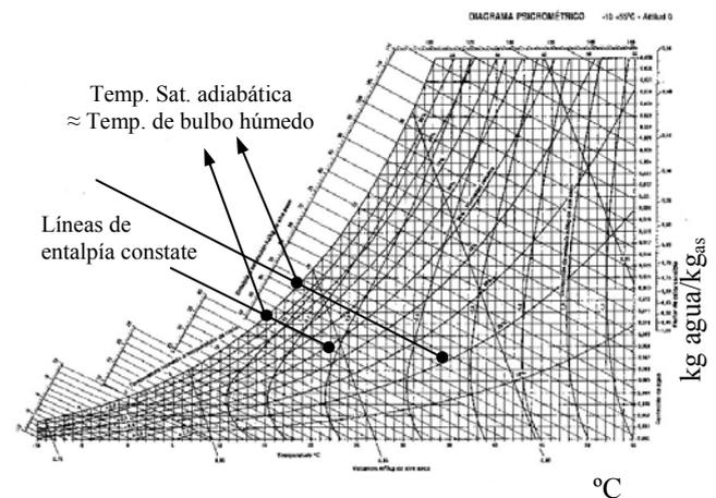
Fig. 10. Evolución psicrométrica del enfriamiento adiabático del aire.
