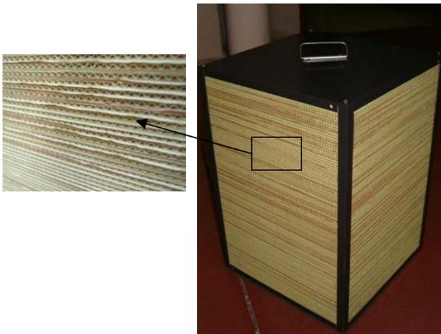
Fig. 4. Efecto de cartón de un recuperador de placas de cartón.
