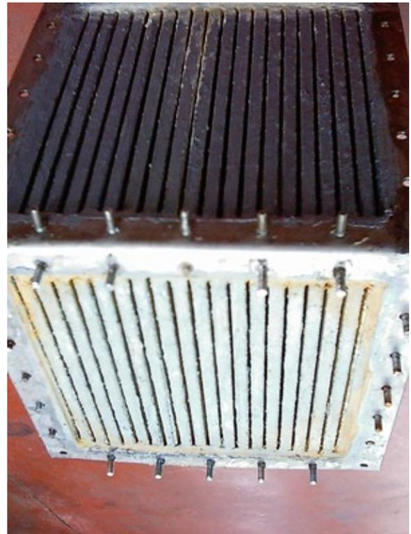
Fig. 5. Recuperador de placas de aluminio.
