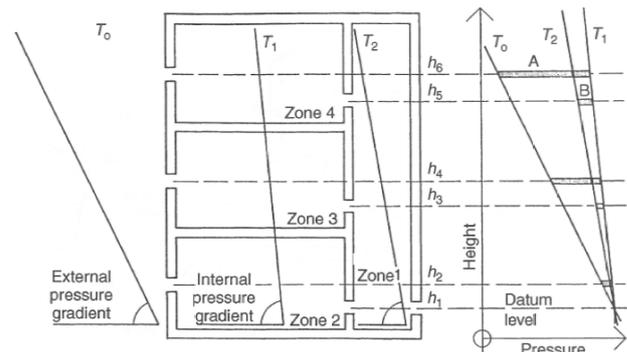
Fig. 18. Presión debida a diferencia de densidades en edificios con zonas conectadas horizontales [2].
