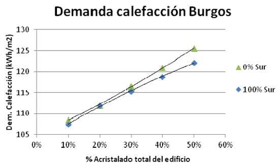
Fig. 16. Variación de la Demanda de Calefacción en función del porcentaje acristalado.
