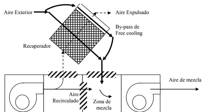
Fig. 25. Sistema combinado free cooling y recuperación de energía.
