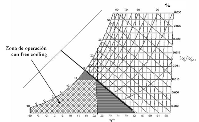
Fig. 27. Zona de control por entalpía en un diagrama psicrométrico.
