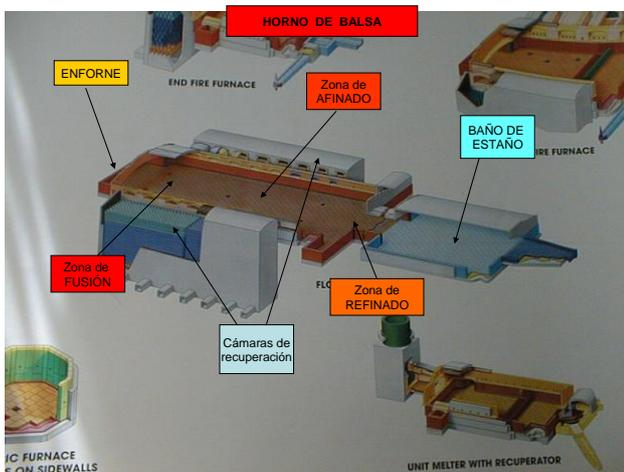
Fig. 6. Horno de balsa para fabricación de vidrio plano. Catálogo de refractarios SEPR.
