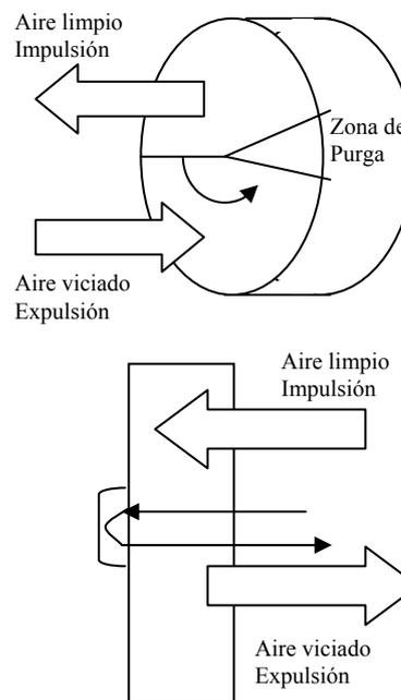
Fig. 8. Funcionamiento de la purga en un recuperador rotativo.
