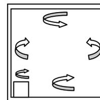
Fig. 5. Intercambio de calor por convección del aire con las superficies interiores.
