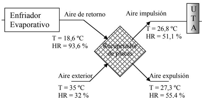
Fig. 22. Operación del recuperador de placas en ciclo de verano, con enfriamiento evaporativo.
