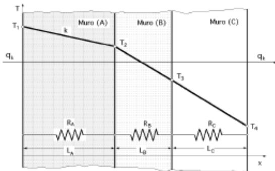
Fig.17. Pared de tres capas y sus resistencias térmicas.
