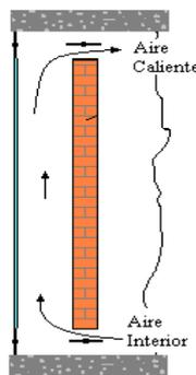
Fig. 21. Funcionamiento del Muro Trombe en Invierno.
