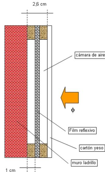
Fig. 19. Film reflexivo colocado en una cámara de aire.
