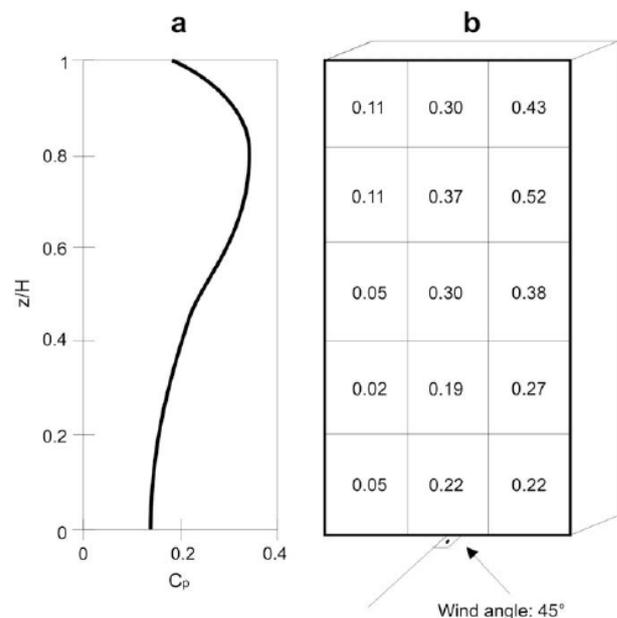
Fig.10. Ejemplo de a) perfil vertical del  $C_p$  medio sobre la fachada de un edificio de aire y b) distribución del  $C_p$  local sobre la superficie [14].
