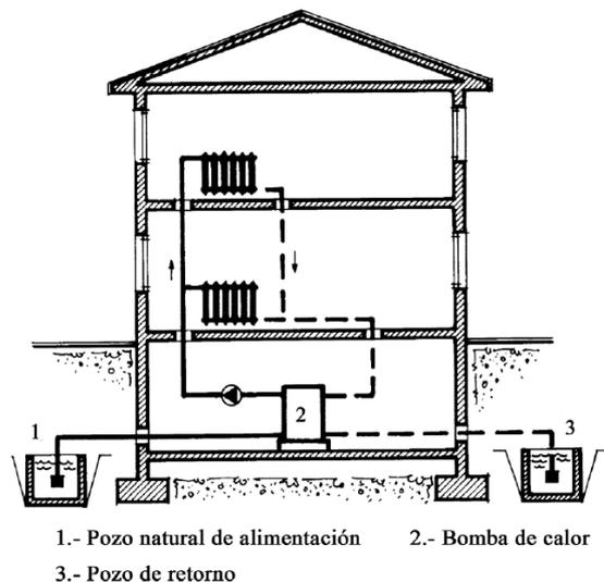
Fig. 9. Bomba de calor agua- agua apoyada para calefacción. Fuente: "Bombas de Calor y energías renovables en edificios". Ed. Thomson ,2005
