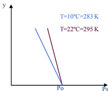
Fig.13. Gradiente de presiones del aire debido a diferencia de densidades.
