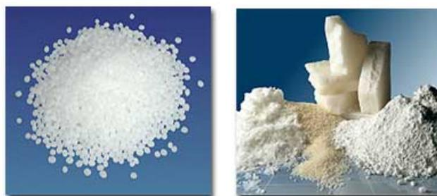
Fig. 7. Imágenes de materiales de cambio de fase suministrados por Rubitherm. A la izquierda, Rubitherm PK. Se trata de un compuesto de cambio de fase atrapado en un entrecruzamiento polimérico, de manera que cuando el compuesto se funde queda atrapado y retenido en la red del polímero. A la derecha, Rubitherm RT. Se trata de parafinas con punto de fusión a diversas temperaturas. (Imágenes e información propiedad de: <http://www.rubitherm.de>)
