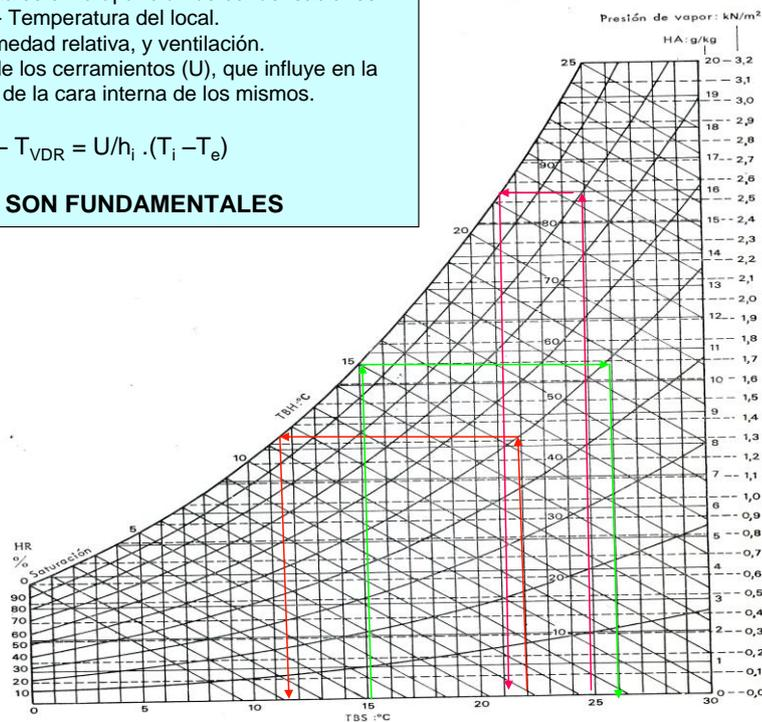
Fig. 42. Ábaco psicrométrico.
