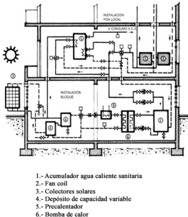
Fig. 10. Instalación de bomba de calor agua-agua con colectores solares en edificio público. Fuente: "Bombas de Calor y energías renovables en edificios". Ed. Thomson, 2005.
