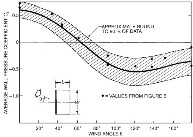
Fig. 12. Variación del coeficiente de presión medio en edificios de baja altura en función de la dirección del viento [16].
