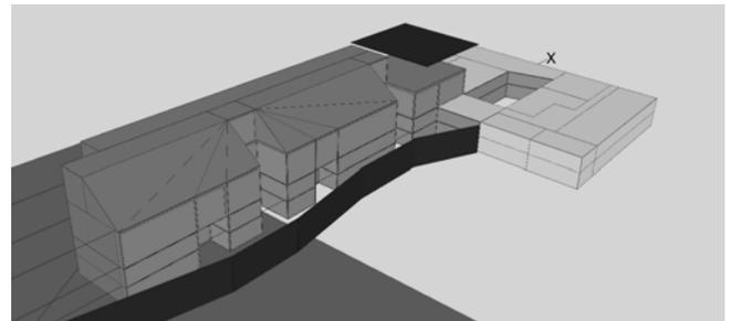
Fig. 36. Modelo del edificio desarrollado en Calener VYP para obtención del edificio de referencia y sus coeficientes de reparto.
