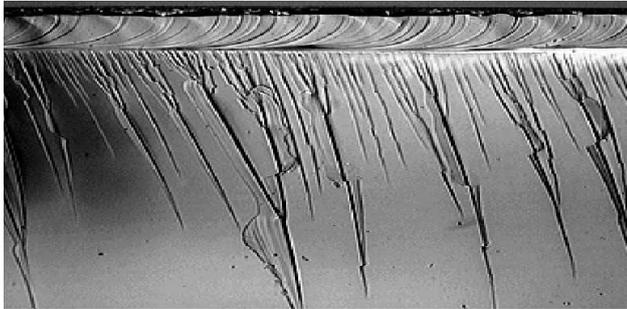
Fig. 48. Fisuras del borde de corte de un vidrio a “canto vivo” sin pulir. El borde superior corresponde al de desplazamiento de la rula. [6] DECOUPE A VERRE PLAT. S.G. Recherche.
