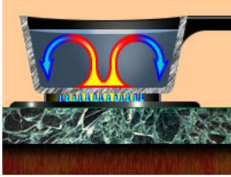
Fig. 9. Convección en el interior de un recipiente.
