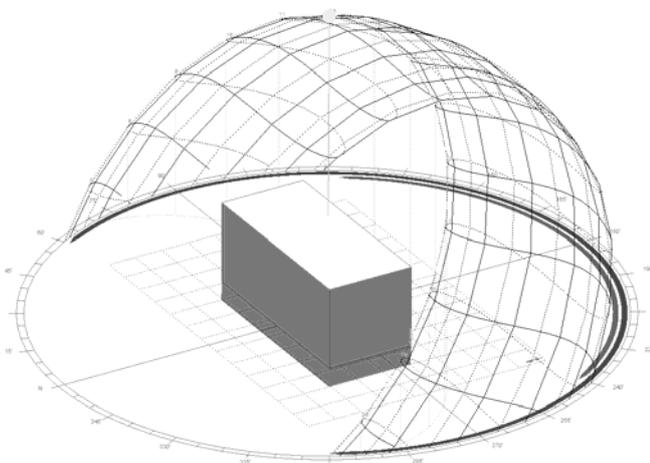
Fig. 24. Representación de la trayectoria solar en Sevilla (ECOTECT).
