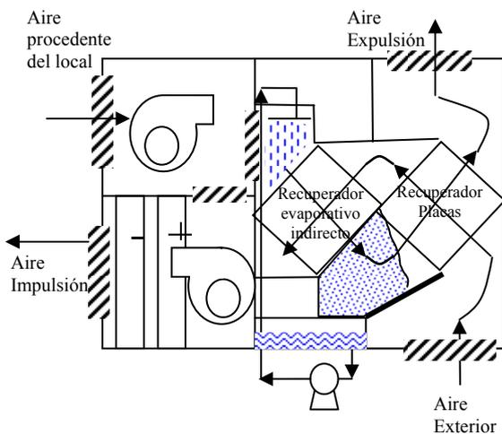
Fig. 11. Esquema de operación de un recuperador evaporativo.
