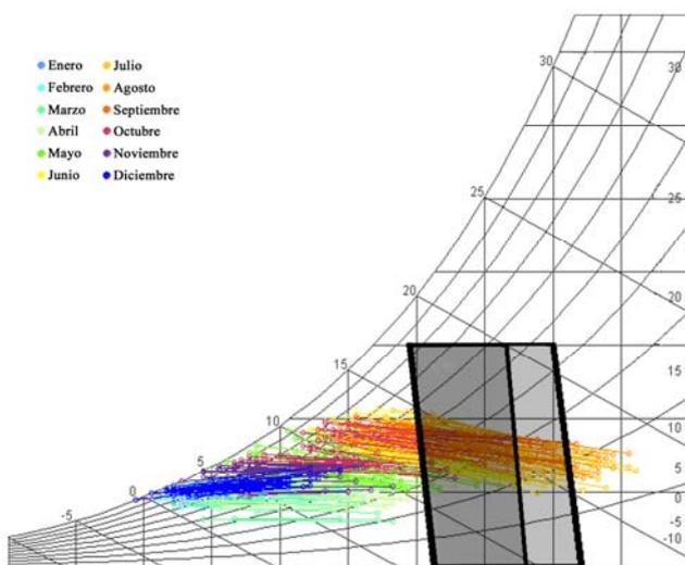
Fig. 17. Enfriamiento mediante ventilación forzada.
