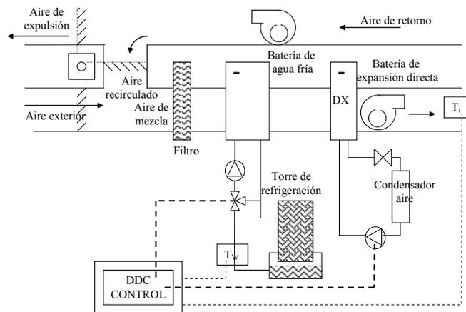
Fig. 31. Esquema de operación y control de un free cooling por agua.
