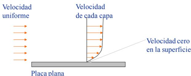
Fig.3. Condición de no deslizamiento.
