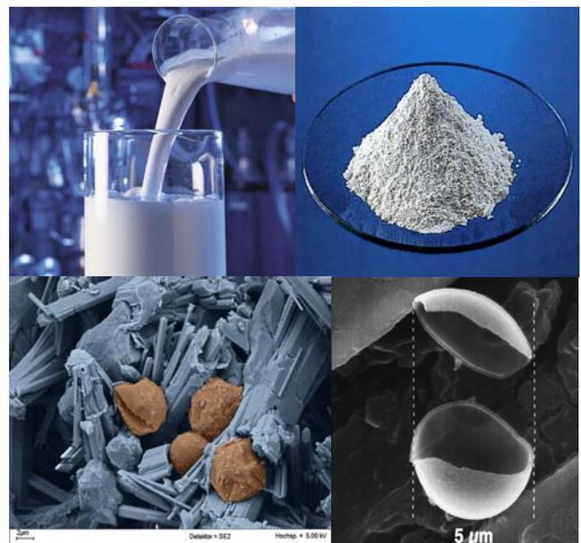
Fig. 8. Las imágenes superiores corresponden a Micronal (slurry y polvo). Las imágenes inferiores muestran las cápsulas poliméricas en cuyo interior se encuentra la parafina. (Imágenes e información propiedad de Micronal –BASF: <http://www.micronal.de/>)
