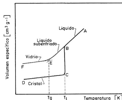
Fig. 3. Comportamiento térmico de un sólido vítreo y otro cristalino. [1] EL VIDRIO Capítulo 2.
