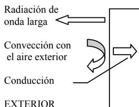
Fig. 3. Mecanismos de intercambios de calor en una superficie exterior.
