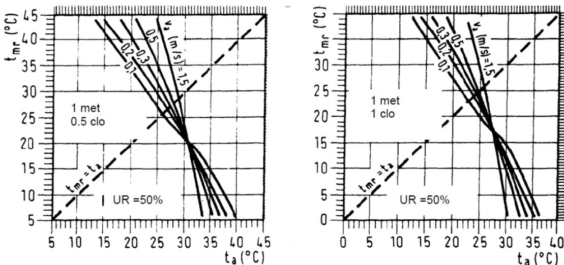
Fig.4. Curva de isoconfort.
