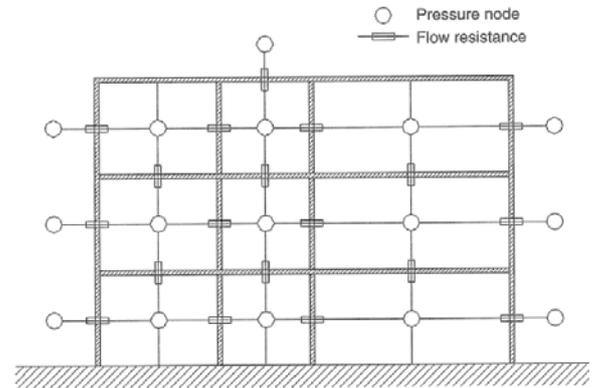
Fig.23. Esquema de modelado de ventilación natural de un edificio a) unizona; y b) multizona. [6].
