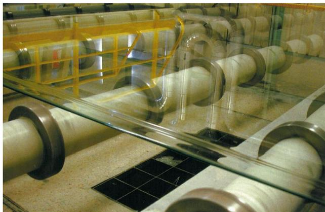
Fig. 9. Hoja de vidrio en la extendería, a la salida del recocido.
