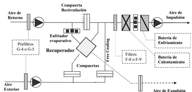
Fig. 19. Esquema de operación de la instalación.
