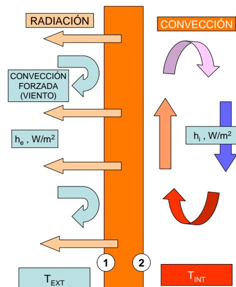
Fig. 21. Flujo del Calor a través de un vidrio sin participación de la Radiación Solar.
