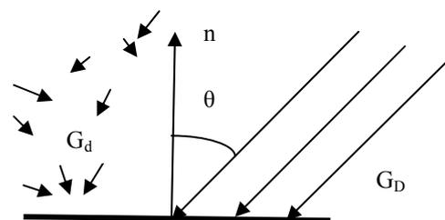
Fig.15. Radiación directa y difusa que inciden sobre una superficie horizontal en la superficie terrestre.
