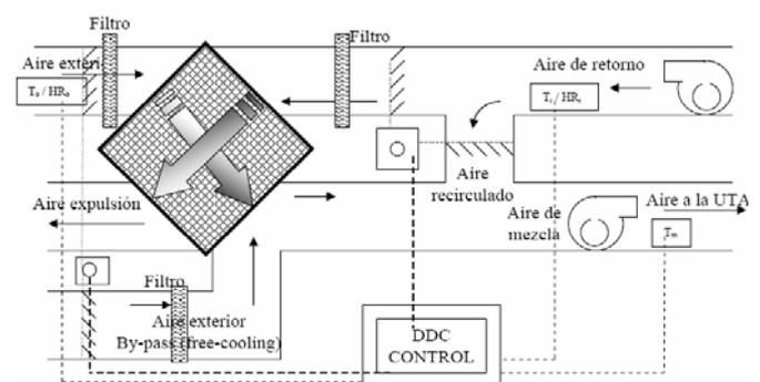
Fig. 33. Esquema de operación y control de un free cooling combinado con un sistema de recuperación de energía.
