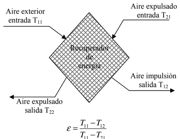
Fig. 1. Esquema del proceso de recuperación de energía en un sistema de climatización por aire.
