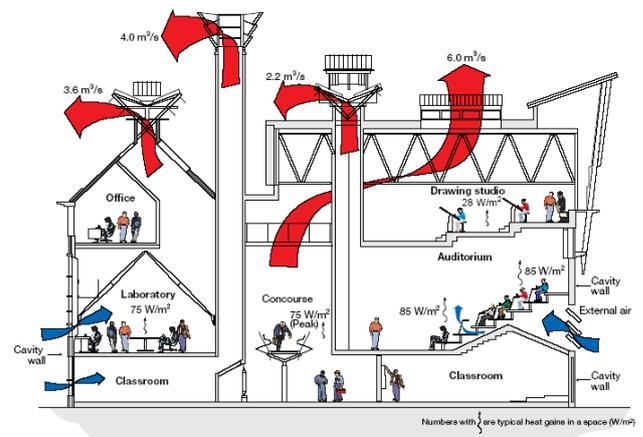
Fig.38. Estrategia de ventilación natural en el módulo central del edificio Queen [85].
