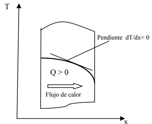
Fig. 7. Gradiente de temperatura y flujo de calor.
