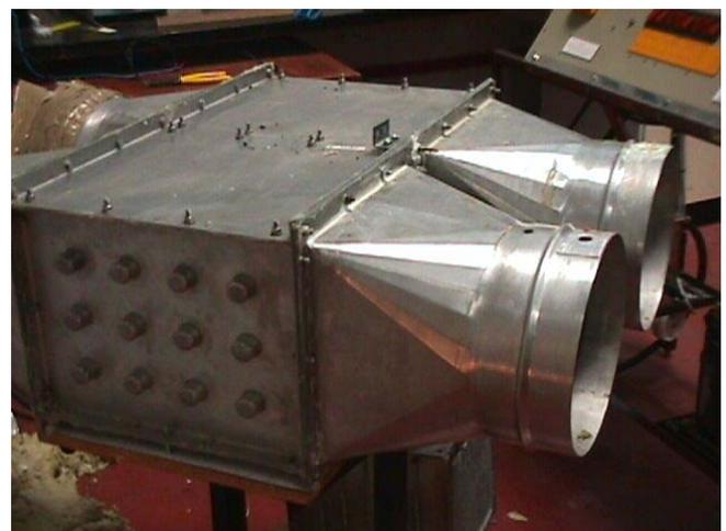
Fig. 15. Batería de heat pipe aleteados en acero inoxidable.
