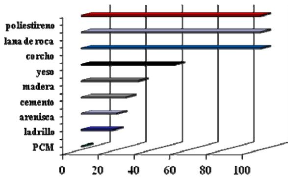
Fig. 4. Espesor relativo requerido para acumular una misma cantidad de calor en distintos materiales de construcción. Fuente propia.
