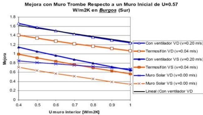
Fig. 23. Mejora de la transmitancia del muro base tras la colocación de un muro trombe.
