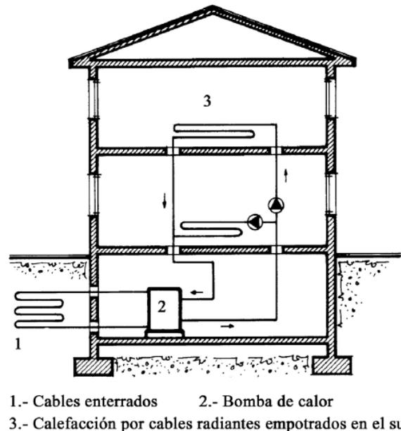
Fig. 11. Calefacción por bomba de calor tierra-agua con suelo radiante. Fuente: "Bombas de Calor y energías renovables en edificios". Ed. Thomson, 2005
