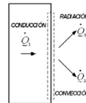
Fig. 2. Flujos de calor en la superficie de un cerramiento.
