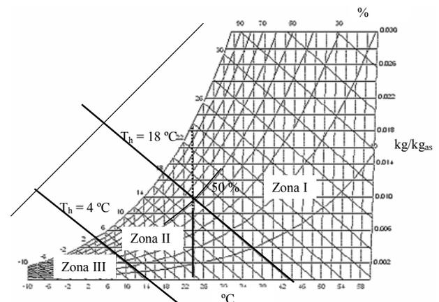
Fig. 32. Zonas recomendadas de control de un free cooling por agua.
