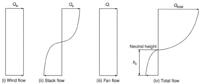
Fig.21. Componentes del caudal total de aire: caudal debido al viento; caudal debido a diferencia de densidades; caudal debido a ventiladores [2].
