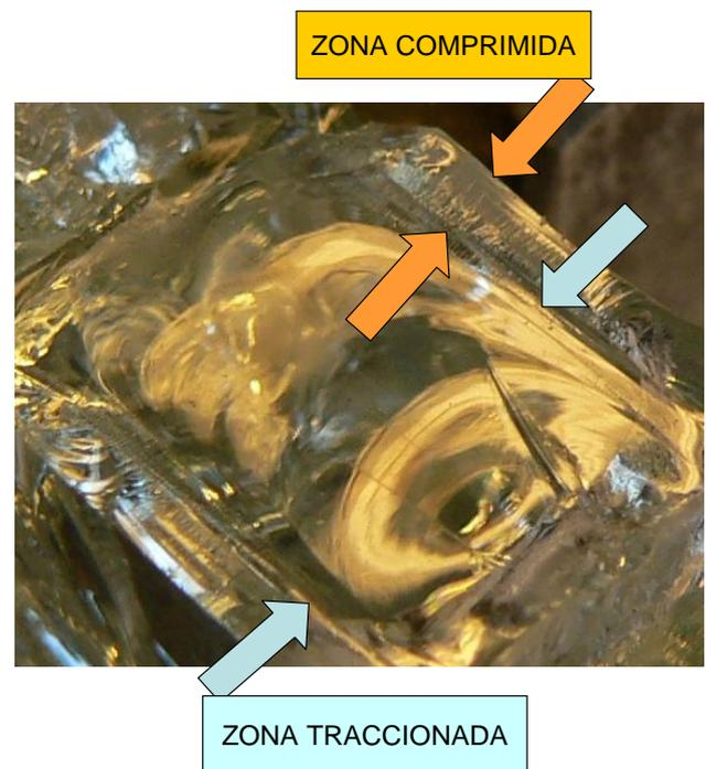
Fig. 51. Vista del canto de un fragmento de vidrio templado fracturado donde reaprecian las diferentes zonas de tensión y su profundidad.
