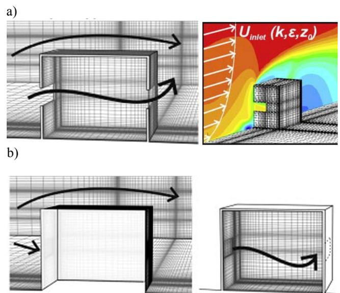
Fig.26. Modelado CFD de ventilación natural a) aproximación acoplada; b) aproximación desacoplada [38].
