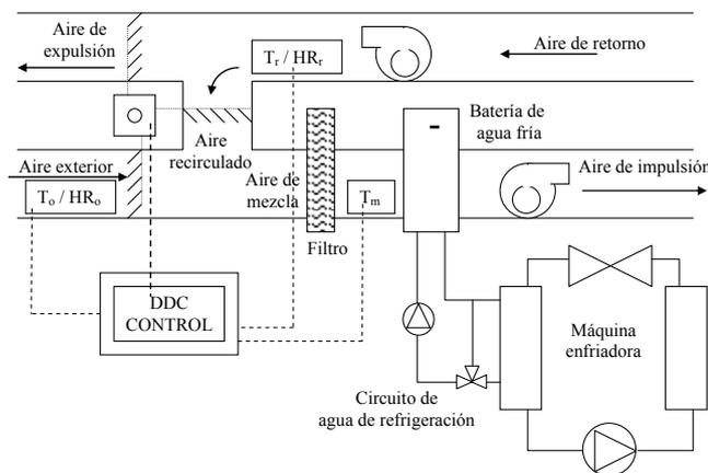
Fig. 26. Esquema de operación y control por entalpía de un free cooling por aire.
