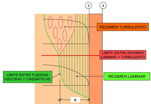
Fig. 32. Detalle de la Zona A. Movimiento del aire en convección natural.
