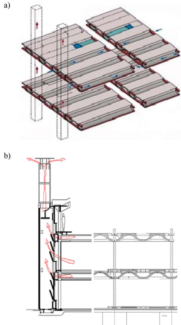
Fig.41. Estrategia de ventilación natural mediante forjado ventilado. a) Vista isométrica y b) alzados [88].
