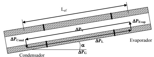
Fig. 12. Esquema de operación de un tubo de calor.
