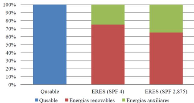
Fig. 2. Cuota de energía renovable y auxiliar en una Bomba de Calor con un  $\eta = 0,4$ . Fuente: EUROSTAT.
