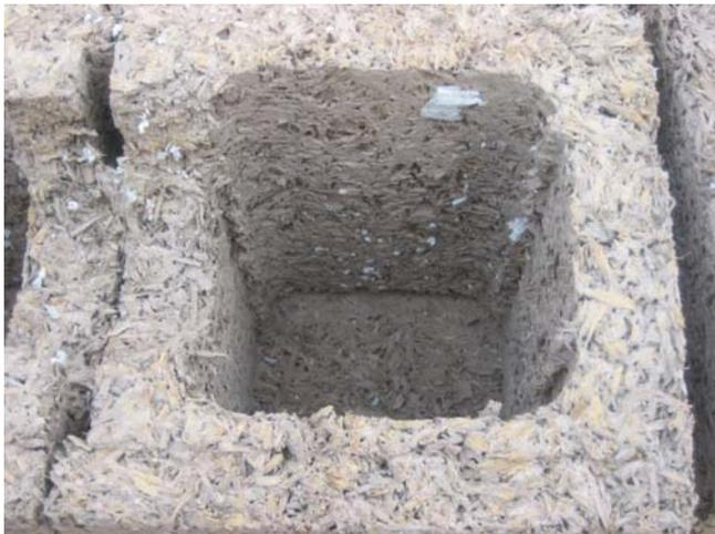
Fig. 26. Nuevos materiales desarrollados con concepciones ecoeficientes deben competir con productos tradicionales sometidos a exigencias menores, lo que dificulta su competitividad. Bloque CLIMABLOC fabricado con residuos de madera.
