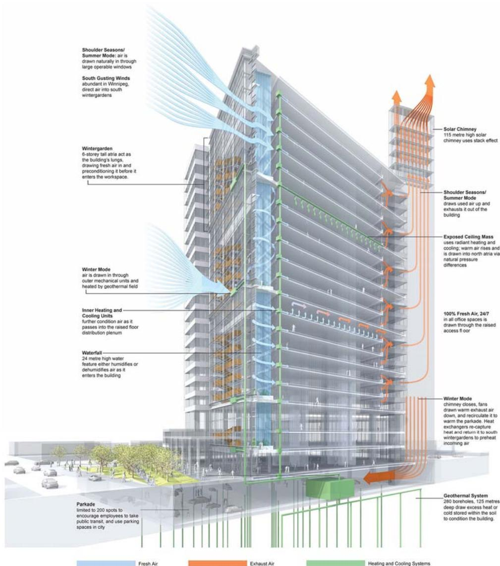
Fig. 15. Oficinas de Manitoba Hydro, Winnipeg, Canadá. La doble fachada activa del edificio aprovecha los vientos dominantes y los precalienta/preenfria para proveer el aire de renovación del edificio (KPMB arquitectos).
