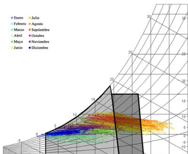
Fig. 20. Ganancias solares y alta masa térmica.
