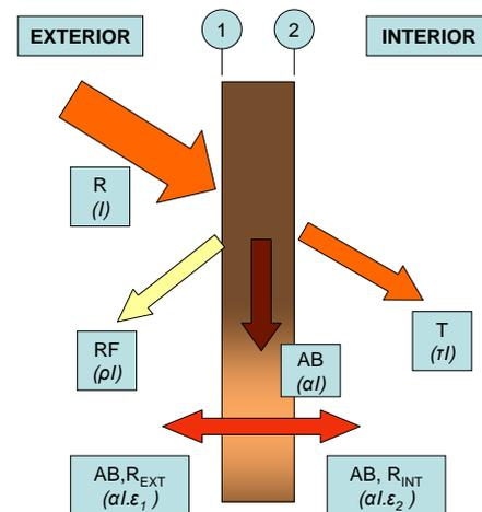
Fig.19. Esquema genérico del mecanismo de Radiación
