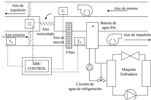
Fig. 28. Esquema de operación y control por temperatura de un free cooling por aire.
