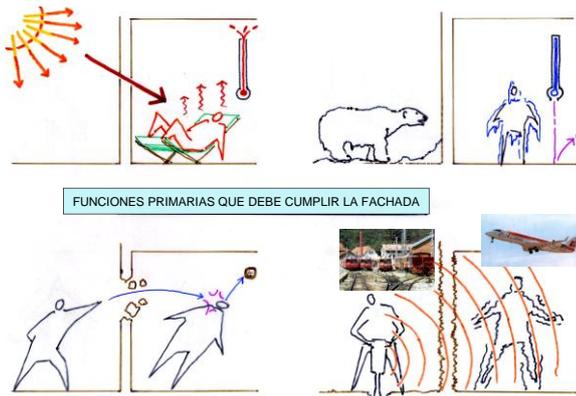
Fig. 11. Condiciones mínimas que debe cubrir una fachada
