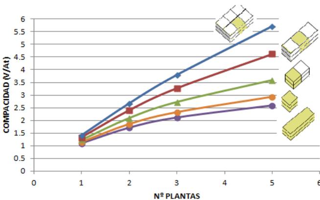
Fig. 14. Variación de la compacidad en función de la tipología arquitectónica del edificio y del número de plantas.
