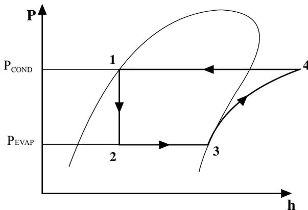
Fig. 5. Diagrama P-h del ciclo simple por compresión de vapor.
