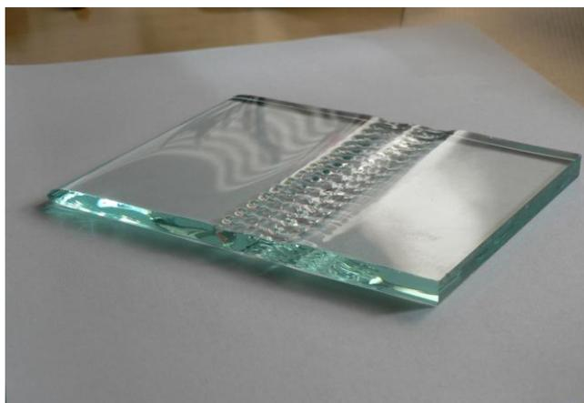
Fig. 10. Detalle de las marcas de los "Top rollers".
