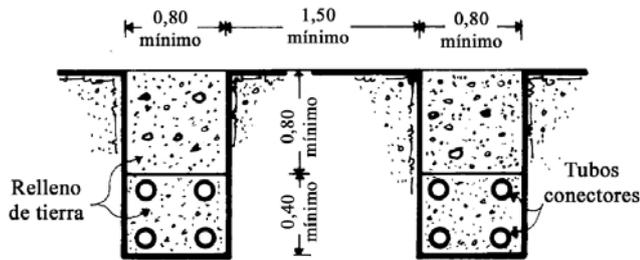
Fig. 12. Zanjas tipo para la disposición de los tubos colectores del sistema tierra-agua. Fuente: "Bombas de Calor y energías renovables en edificios". Ed. Thomson, 2005
