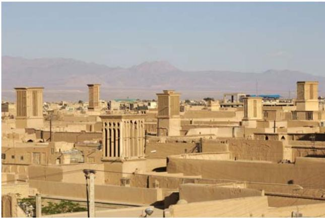
Fig. 13. Zona urbana tradicional con torres de viento para favorecer la refrigeración de los edificios dificultada por la densidad urbana.
