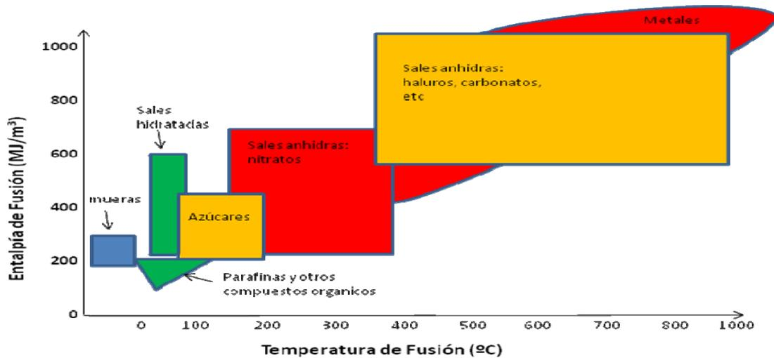
Fig. 3. Familias de PCMs en función de la temperatura y entalpía de fusión.
