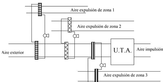
Fig. 18. Esquema de operación de instalación de dos baterías con bomba, utilizando diferentes conductos de retorno y uno de impulsión.
