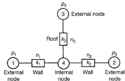
Fig.25. Esquema de red de nodos en una zona [2].
