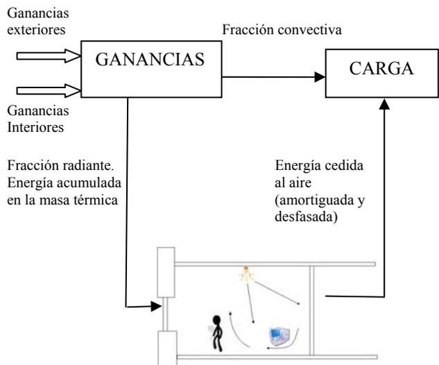
Fig. 6. Diferencia entre ganancia y carga térmica.
