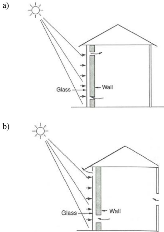
Fig.43. Ventilación inducida por muro Trombe; a) calentamiento en invierno; b) ventilación en verano [2].
