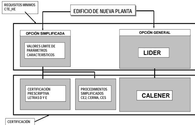
Fig. 5. Relación entre procedimientos de verificación del Código Técnico y procedimientos de certificación.
