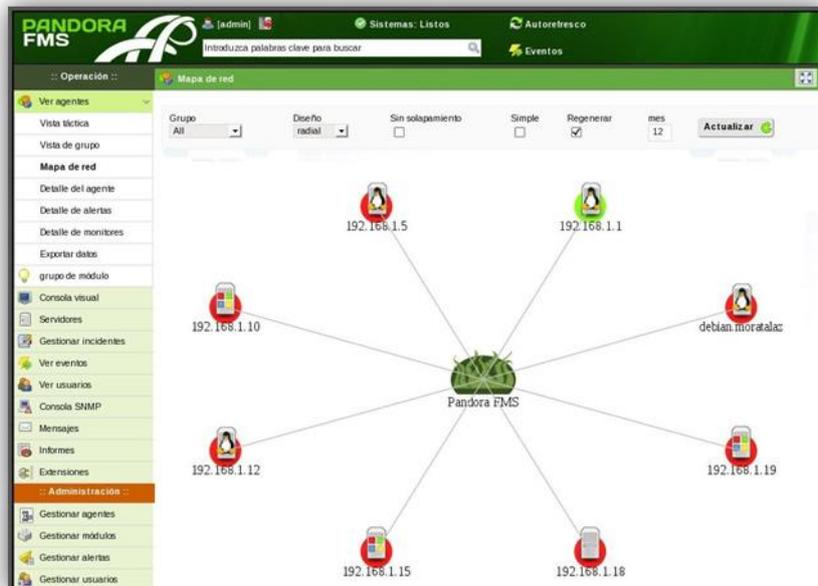
**Ilustración 3-06: Interfaz web con las uniones entre equipos de una red en PandoraFMS.**
