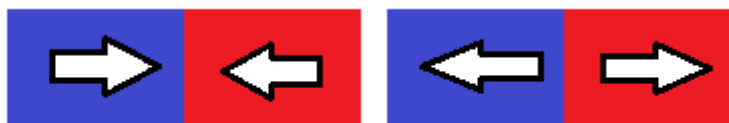
Figura 9: Esquema de una pared head to head a la izquierda, y tail to tail a la derecha. En geometrías planas y materiales blandos estas son el tipo de paredes que nos encontramos.
