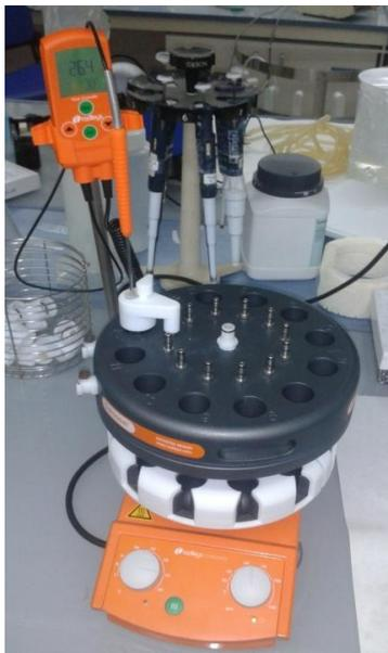
Figura 7. Dispositivo de agitación magnética (Carousel 12 Plus, Radleys, Essex, Reino Unido).
