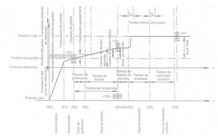
En el siguiente gráfico, velocidad, presión y acortamiento durante el ciclo de soldadura:
