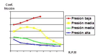
• El coeficiente de fricción disminuye después del primer contacto de fricción, ved esquema:
