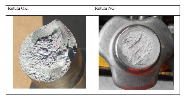
En GKN Driveline Zumaia, solo se controla la fuerza aplicada durante el ensayo.
