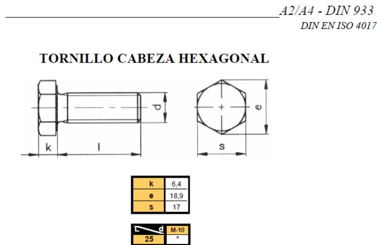
Figura 2.108 Tornillos de la tapa de cierre
