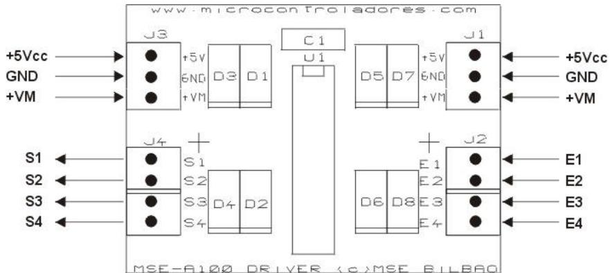
El driver MSE-A100 puede controlar diferentes tipos de cargas. A continuación se muestra, a modo de ejemplos, la conexión de MSE-A100 con diferentes tipos de periféricos. Así, la figura 4, muestra la conexión del driver con cargas luminosas de tipo led.
