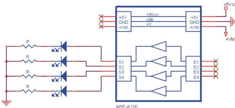
La resistencia R de absorción asociada a cada led se debe calcular en función de la tensión +VM empleada según la siguiente fórmula:  $R = (+VM - VLED) / ILED$
