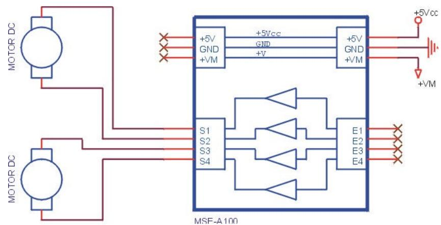
La figura 6 muestra la forma de conectar, a modo de ejemplo, dos relés y dos motores CC. En este caso tanto los relés como los motores se conectan a cada una de las 4 salidas disponibles, por lo que únicamente pueden tener el estado ON/OFF. En el caso de los motores sólo pueden tener un único sentido de giro, que será horario o antihorario en función de cómo se realicen las conexiones de los mismos.
