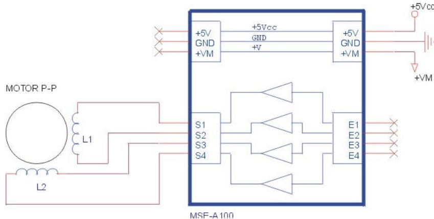
Según las combinaciones binarios que se apliquen por las entradas E1-E3, las bobinas se excitan con una determinada polaridad y produciendo un desplazamiento de rotación en el eje del motor. El número de grados de esta rotación o “paso” dependerá del motor empleado. Las siguientes tablas muestran las secuencias binarias que han de aplicarse para producir un giro en uno u otro sentido.
