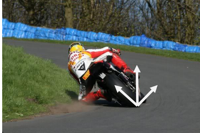
Figura[3.91]. Descomposición de fuerza debida a un bache, sobre el sistema de referencia móvil de la moto.
