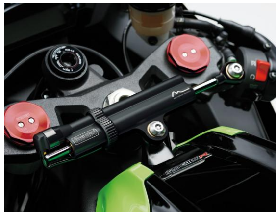
Figura[3.3]. Solución más habitual de amortiguación de la dirección.
