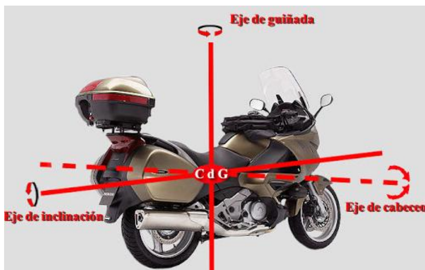
Figura[3.4]. Representación de los ejes de la moto.
